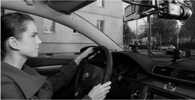
Abb. 3.10: Eye-Tracker Smart Eye im Versuchsfahrzeug mit einer Szenenkamera zur Verkehrsbeobachtung (neben dem Rückspiegel) und Kameras für die Blickmessung auf dem Armaturenbrett (Bildquelle: Karin Lange, OvGU Magdeburg).
