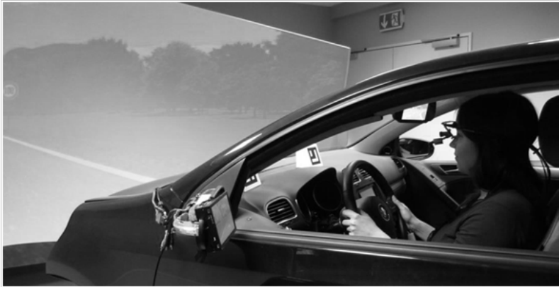
Abb. 3.20: Statischer Fahrsimulator vor einer sphärischen Leinwand mit auf dem Armaturenbrett befestigten Markern für das Dikablis Blickregistrierungssystem Studie 2.
