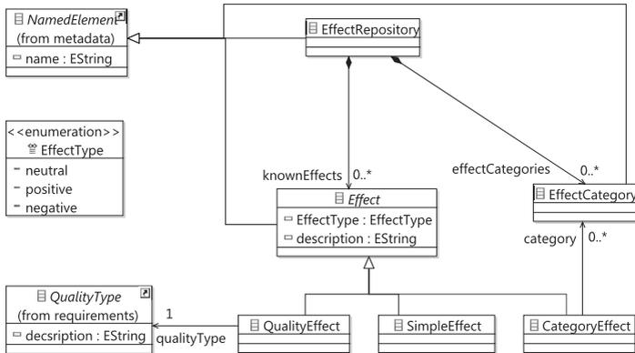
Figure 4.26.: Effects Meta-Model Package
