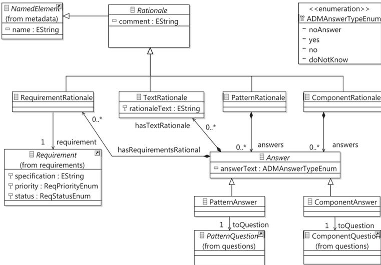
Figure 4.37.: Rationales Meta-Model Package
