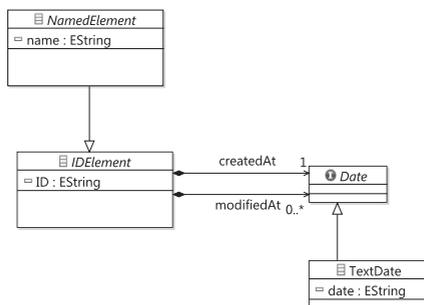
Figure 4.25.: Metadata Meta-Model Package
