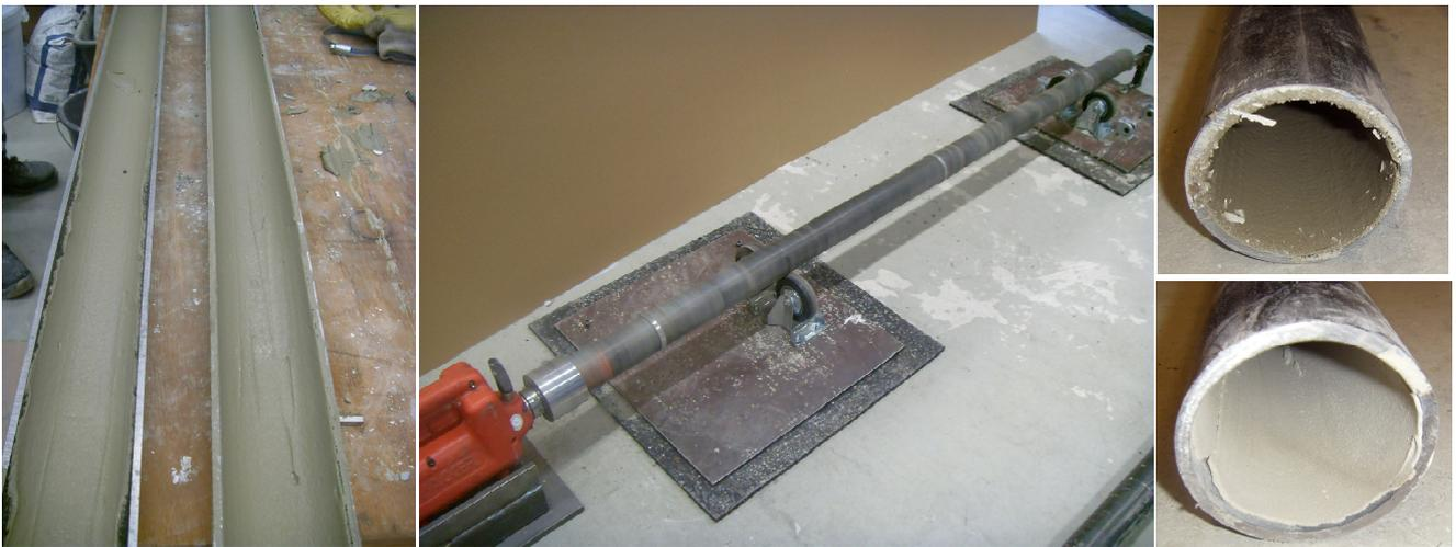
Abbildung 57: Einbringen der Ablagerungen in Rohrhälfte (links), gleichmäßige Verteilung der Ablagerungen durch die Drehung des Rohrs (Mitte) und nachgebildete Ablagerung im Rohr der Länge von 2 m (rechts)
