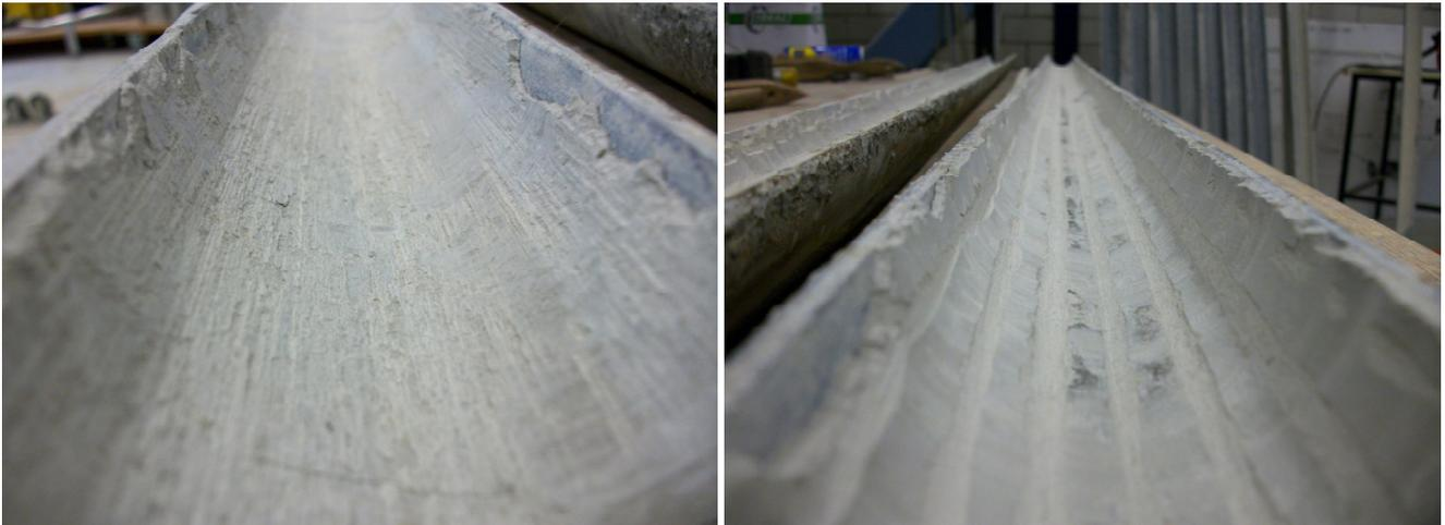
Abbildung 73: Abtragbild mit freier Drehung (links) und blockierter Drehung (rechts) des Werkzeugträgers
