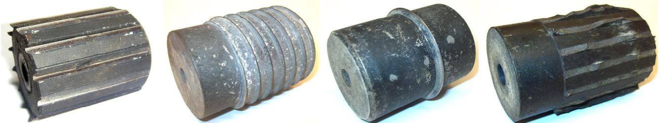
Abbildung 21: Werkzeuggeometrie mit  $d = 56$  mm (von links): längs, schraubenförmig und quer zur Werkzeugachse angeordnete Keilformen. Bild rechts: Bruch von Werkzeugkanten aufgrund eines kleinen Keilwinkels
