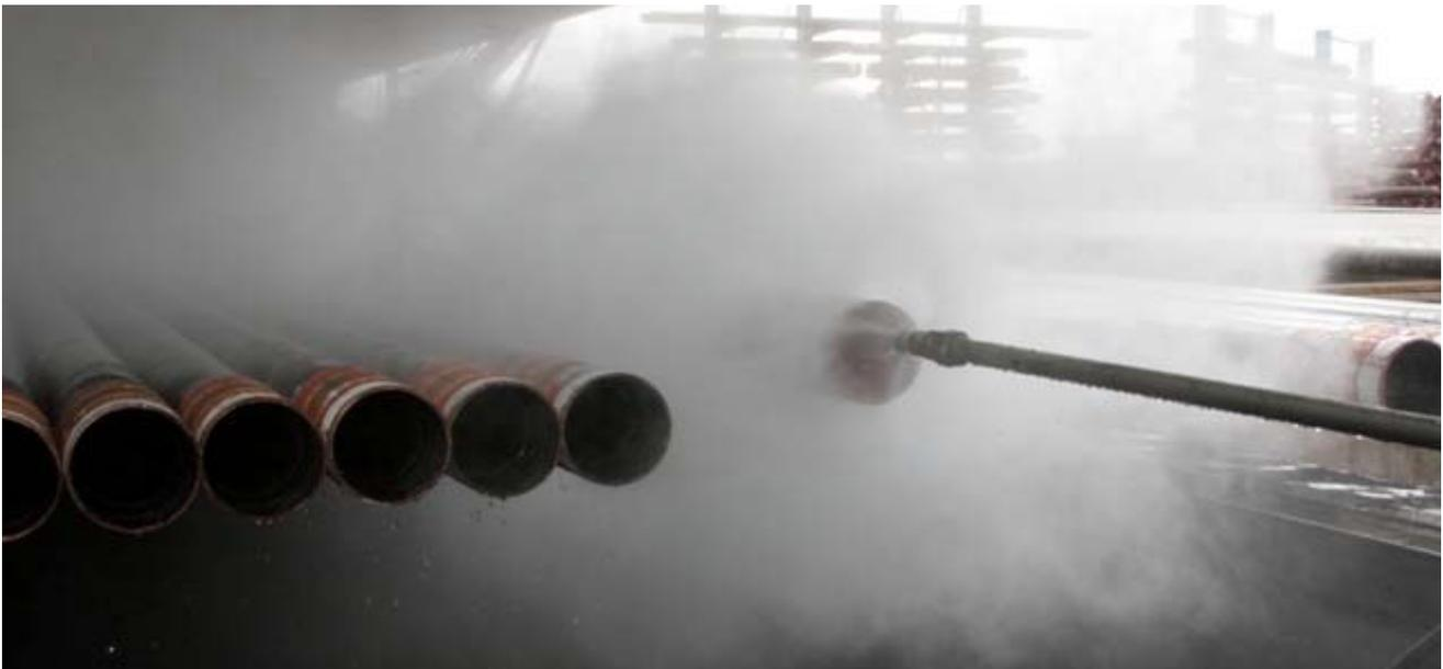
Abbildung 4: Dekontamination von Rohren mittels Hochdruckwasserstrahlverfahren [Var-10]
