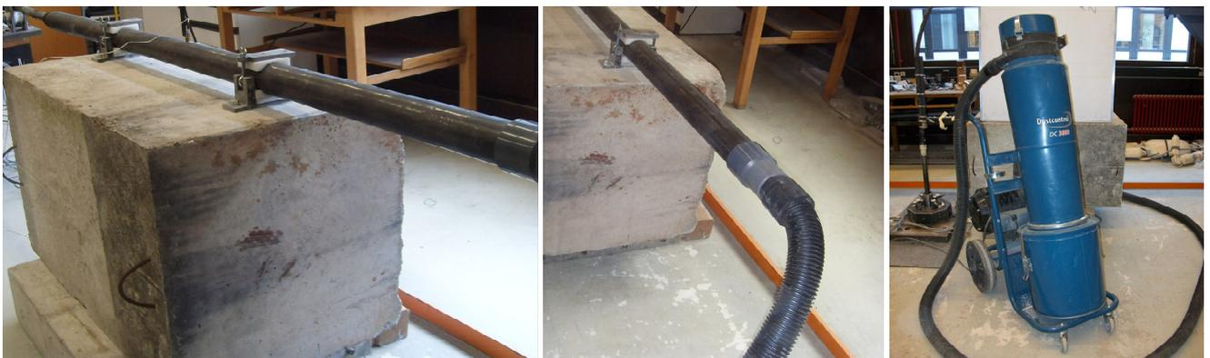
Abbildung 58: Einspannvorrichtung, Saugstutzen und Saugereinheit
