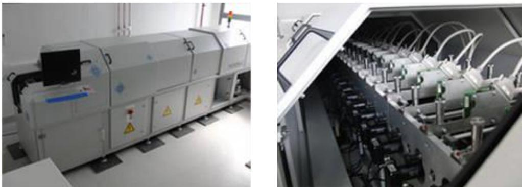
**Abbildung 11: Peptidlaserdrucker der Firma PEPPERPRINT GmbH (links). In Reihe angeordnete Druckwerke (rechts). [44]**
