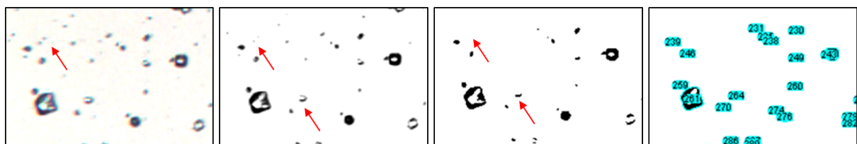
Abbildung 4.4: Fehler in der Bildanalyse: Verlust von kleinen Partikeln und Fehlmessung von Kristallen mit unscharfen Kanten
