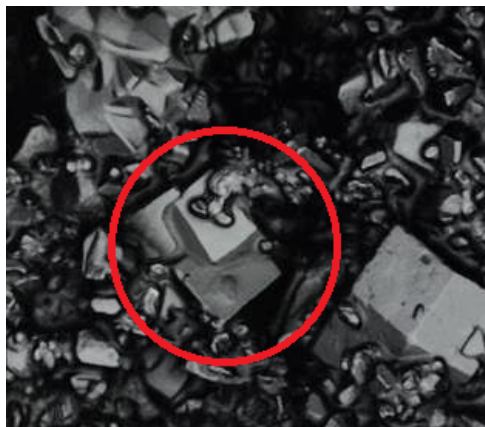
Abbildung 7.17: LSM-Aufnahme eines bei 2 bar für 1 Minute gepressten Filterkuchens - Durch plastisches Fließen an einen größeren Kristall angehafterter kleiner Kristall (siehe Partikel in rot umrandeten Gebiet)
