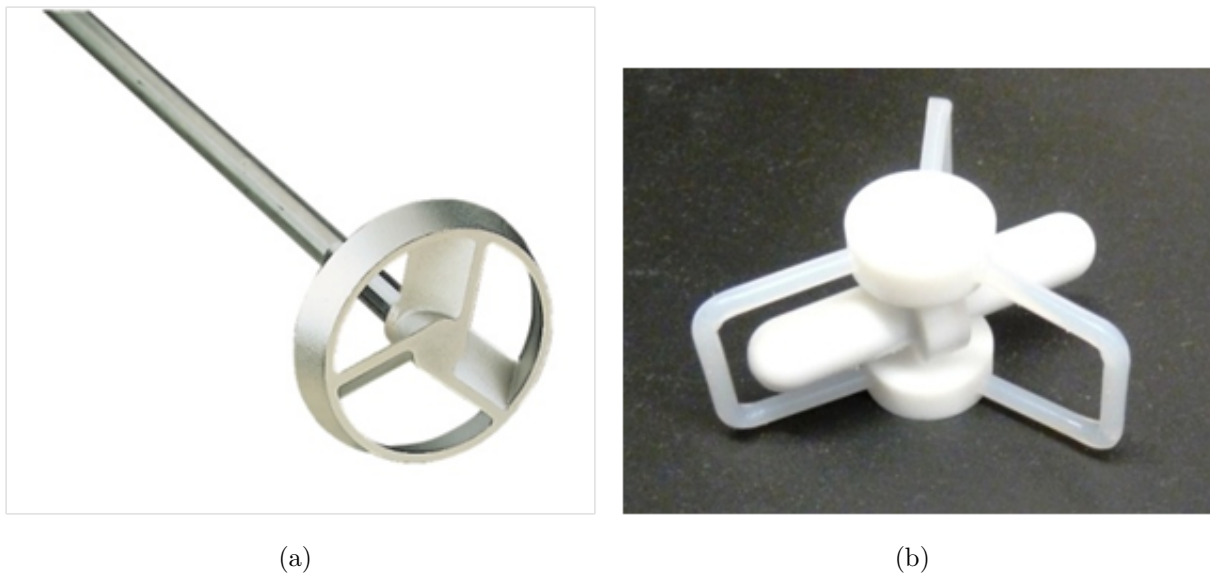
Abbildung 4.1: Für die Kristallisationen eingesetzte Magnetführer: (a) Turbinenrührer zur Herstellung isometrischer Kristalle (b) Schwimmer-Magnetführer zur Herstellung nadelförmiger Kristalle
