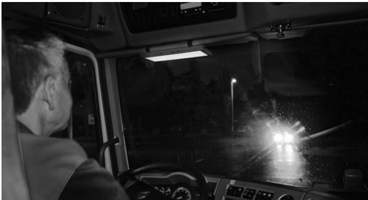
Abbildung 4.21: Illustration des Antiblendlichts, welches, an der Sonnenschutzblende angebracht, die Blendung durch andere Verkehrsteilnehmer reduzieren soll [100].
