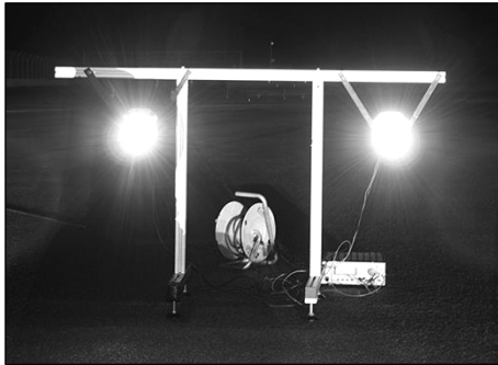
Abbildung 4.30: Projektionsmodule an einem Profilschienerack zur Simulation eines entgegenkommenden Fahrzeugs
