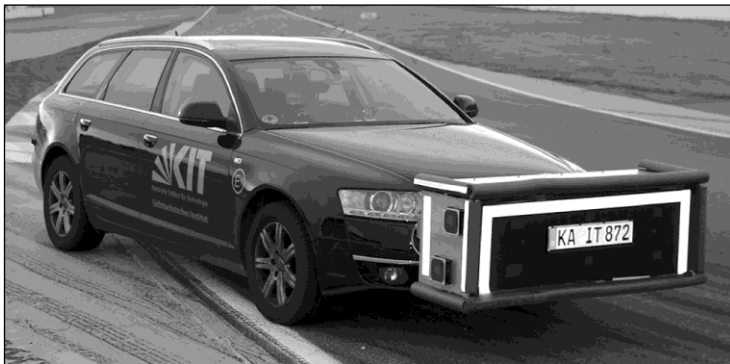
Abbildung 3.5: Propix -Versuchsfahrzeug mit montiertem Rack. Zur einfacheren Identifizierung als Forschungsfahrzeug wurde eine retroreflektierende Folie auf den Außenwänden angebracht.
