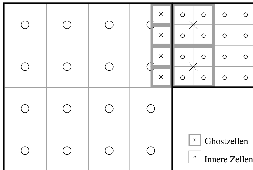
Abbildung 2.7.: Ghostzellen im Überlappungsbereich zweier benachbarter Blöcke mit Segmentierung (Darstellung einer Ghostzellreihe)
