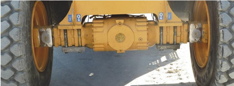
Abbildung 6.11: Realisierung des DMS-Radlastmesskonzepts
