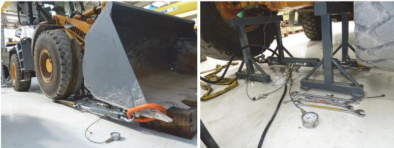
Abbildung 6.10: Versuchsaufbau zur Aufbringung von Längs- sowie Querkräften im Reifenlatsch
