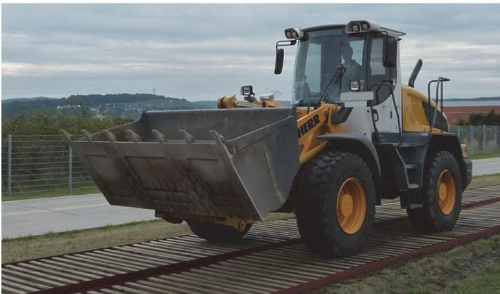
Abbildung 6.27: Versuchsfahrzeug auf der Schlechtwegstrecke nach ISO5008 (smooth track)
