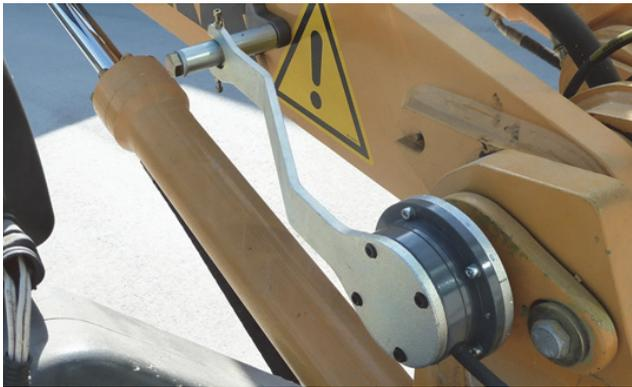
Abbildung 6.4: Montagesituation des Winkelgebers zur Bestimmung des aktuellen Hubwinkels
