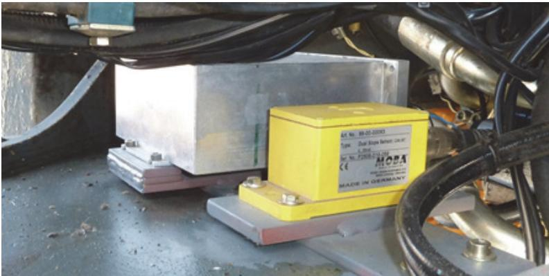
Abbildung 6.5: Einbausituation von Inertial- und Neigungssensoren am Fahrzeug-Hinterwagen
