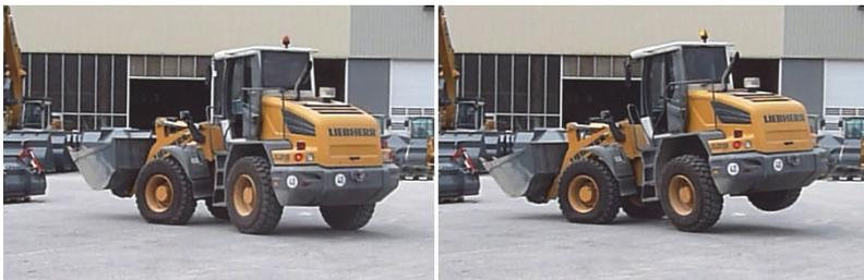
Abbildung 6.22: Abruptes Abbremsen des Fahrzeugs aus einer stationären Kreisfahrt mit voll beladener Schaufel
