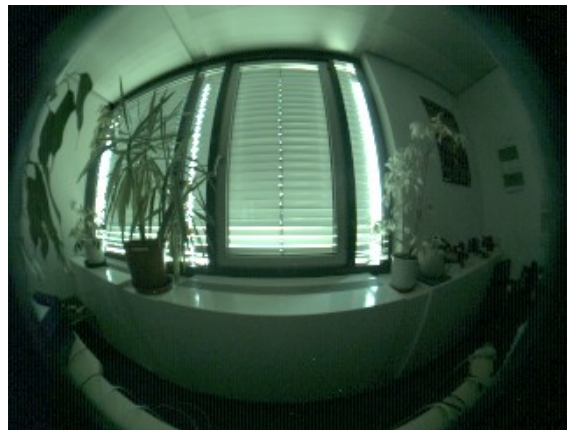
Abbildung 17 Komplett geschlossene Lamellenbehänge bilden im Leuchtdichtebild eine relativ gleichmäßige Fläche ohne kontraststarke Kanten, die Linien werden nicht detektiert. Ergebnis der automatisierten Bildauswertung: Sonnenschutz 0 % geschlossen (elcam-10, 10.07.2008, 15:52 Uhr)
