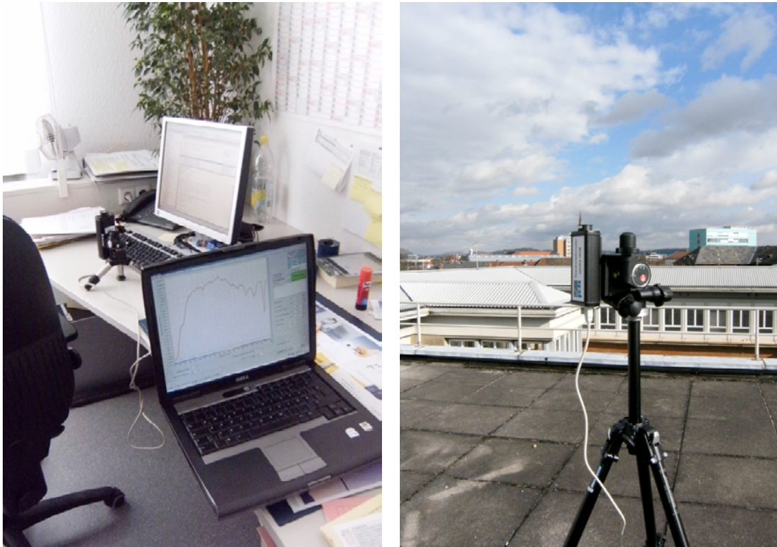
Abbildung 10 Messung des Lichtspektrums am Arbeitsplatz (links; im Monitor des Laptops ist die spektrale Verteilung des Lichts zu erkennen) und gleichzeitig außen auf dem Dach desselben Gebäudes oder eines Gebäudes in unmittelbarer Nachbarschaft (rechts). Das Foto zeigt, dass der Aufbau bei noch nicht völlig bedecktem Himmel erfolgte. Die Messungen wurden bei größerem Bedeckungsgrad durchgeführt.
