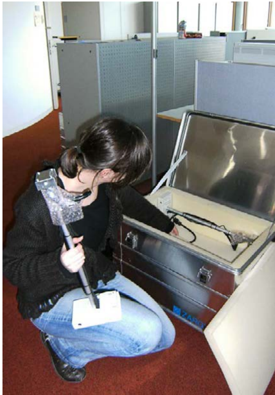
Abbildung 7 Aufbau der Leuchtdichtekamera mit Luftpolsterfolie zum Schutz der Linse beim Auf- und Abbau sowie beim Transport (links) und Leuchtdichtekamera mit Stromversorgung nach erfolgtem Aufbau und Starten der Messung (rechts)
