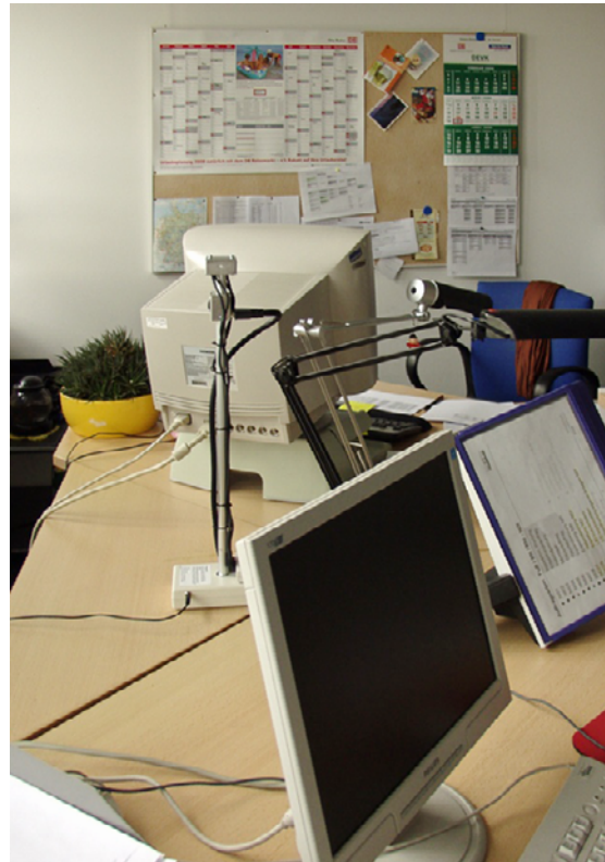
Abbildung 7 Aufbau der Leuchtdichtekamera mit Luftpolsterfolie zum Schutz der Linse beim Auf- und Abbau sowie beim Transport (links) und Leuchtdichtekamera mit Stromversorgung nach erfolgtem Aufbau und Starten der Messung (rechts)
