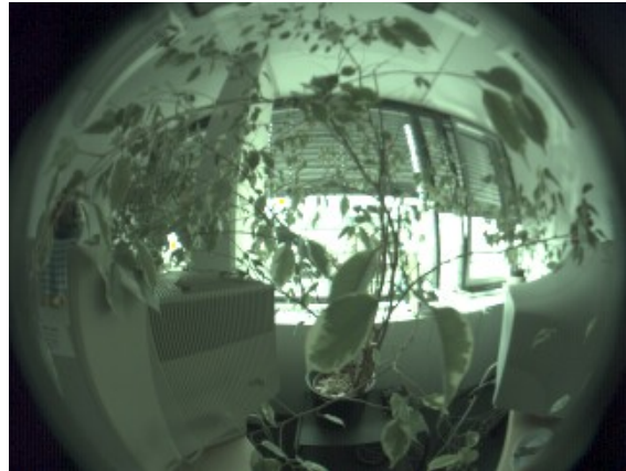
Abbildung 16 Pflanzen vor den Fenstern unterbrechen die Linien des Sonnenschutzes im Bild, die Linien werden nicht detektiert. Ergebnis der automatisierten Bildauswertung: Sonnenschutz 0 % geschlossen (elcam-13, 10.10.2007, 13:40 Uhr)
