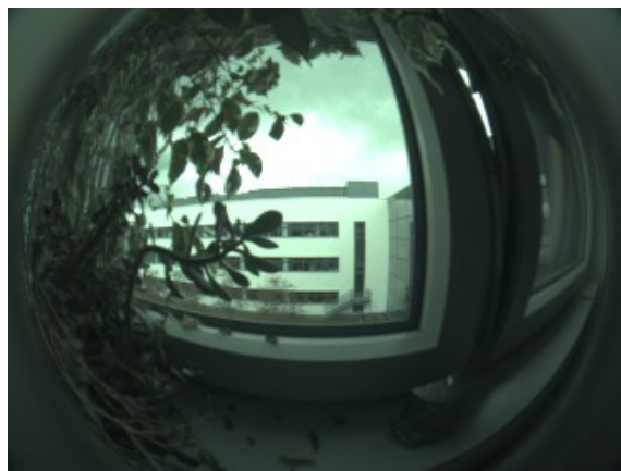
Abbildung 14 Fensterbänder eines gegenüberliegenden Gebäudes oder Gebäudeteils werden als Linie erkannt und als Sonnenschutz fehlinterpretiert. Ergebnis der automatisierten Bildauswertung: Sonnenschutz 80 % geschlossen (elcam-05, 14.04.2008, 16:16 Uhr)
