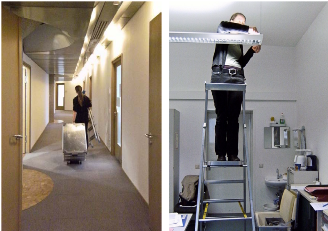
Abbildung 4 Studentische Hilfskraft mit einem der Messtechnik-Koffer und Leiter (links) und beim Anbringen eines Datenloggers an der Deckenbeleuchtung (rechts)
