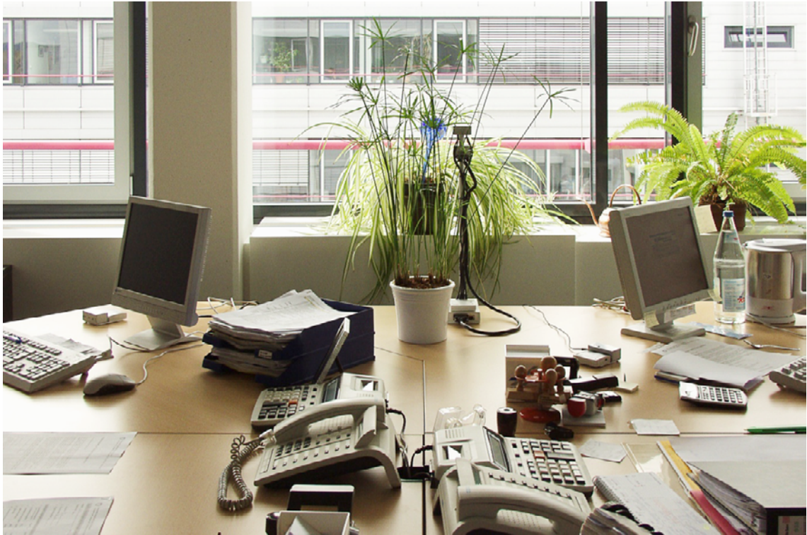
Abbildung 8 Messaufbau in einem der untersuchten Räume mit Leuchtdichtkamera in Fensternähe und Datenloggern in der Nähe der Monitore der beiden Arbeitsplätze
