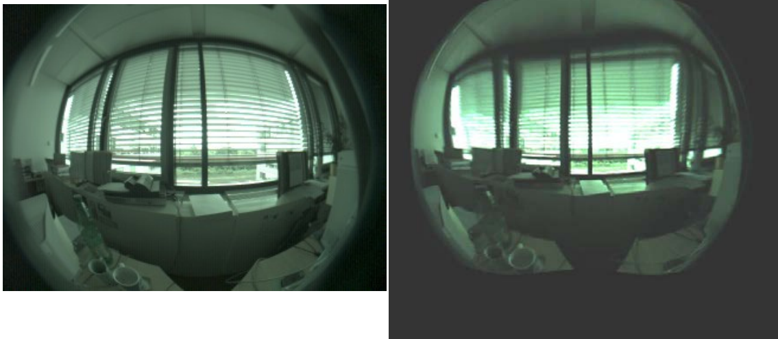
Abbildung 12 Original-Leuchtdichtebild (elcam-07, 07.07.2008, 13:04 Uhr) und Bild nach erfolgter Teilverzerrung
