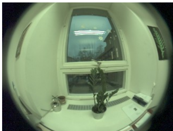
Abbildung 15 Reflexionen in der Fensterscheibe werden als Linie erkannt und als Sonnenschutz fehlinterpretiert. Ergebnis der automatisierten Bildauswertung: Sonnenschutz 69 % geschlossen (elcam-09, 17.12.2008, 08:32 Uhr)
