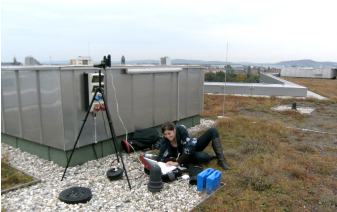
Abbildung 9 Messung des Lichtspektrums auf dem Dach eines Gebäudes
