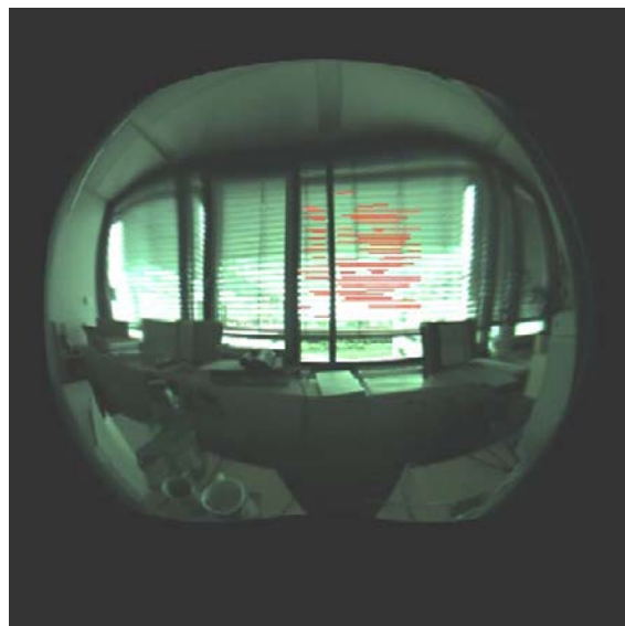
Abbildung 13 Entzerrtes Bild mit rot dargestellten detektierten Kanten im zuvor manuell festgelegten Bereich des Fensters (Ergebnis der automatisierten Bildauswertung: Sonnenschutz 96 % geschlossen)
