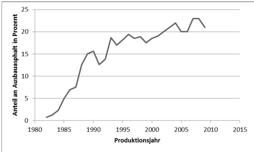
Abbildung 8: Zunahme des RC-Anteil in der Asphaltproduktion in Deutschland seit 1982
