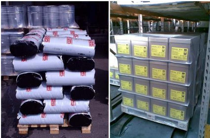
Abbildung 13: Bituminöse Bindemittel in (links:) Schumpffolie und (rechts:) silikonisierten Kartons
