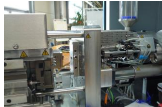
Abb. 3.25: micro-män 50 mit dem für die LIGA2.X-Abformungen verwendeten Werkzeug
