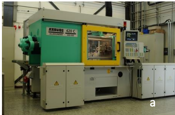
Abb. 6.11: Arburg 420 C des IAM-WPT am KIT: a Spritzgießmaschine; b Detaildarstellung des aufgespannten LIGA2.X-Werkzeuges
