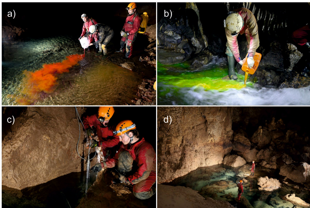
Abbildung 3.4: a) Eingabe (E2) von Sulphorhodamin G, b) Eingabe (E1) von Uranin, c) Einbau des Feldfluorimeters und d) Messstelle „Halle des verlorenen Flusses“ im Blauhöhlsystem. Aufnahmen von A. Kücha, Arge Blautopf (a, c, d) und A. Schober, Arge Blaukarst (b).
