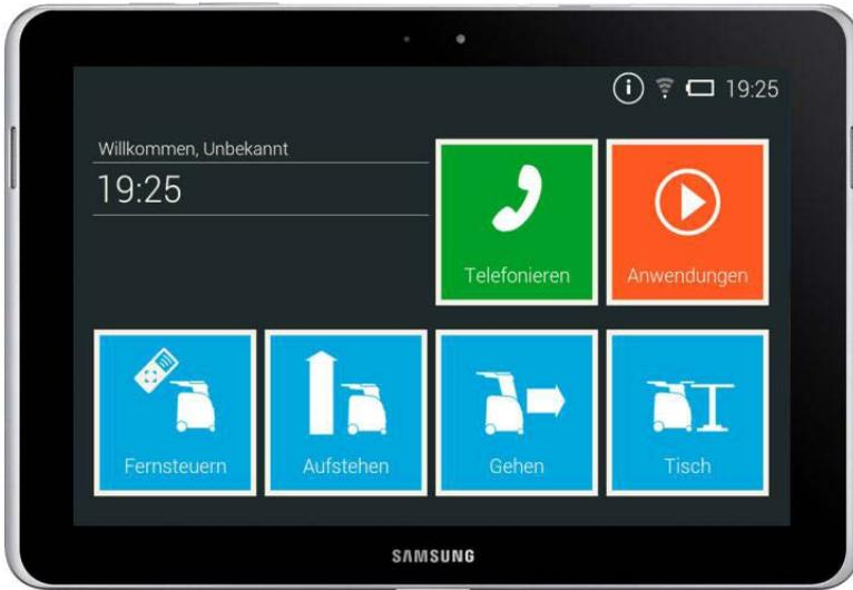
Abbildung 3: Benutzerinterface des multimodalen Interaktionssystems
