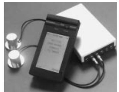
Abb. 3: Das tragbare Engypan-Messsystem besteht aus einem Handy-Computer mit berührungssensitivem Grafikdisplay zur Visualisierung der Messdaten und gammaempfindlichen Sonden mit Spannungsversorgung und Verstärker. Für die Messung des akuten Lungenversagens wurde die Software so modifiziert, dass die Diagnoseergebnisse simultan zur Therapie grafisch dargestellt werden.
