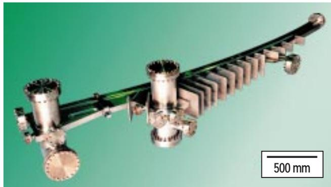
Abb. 3: Fotografie der Vakuumkammer im Bereich eines Ablenkmagneten.
