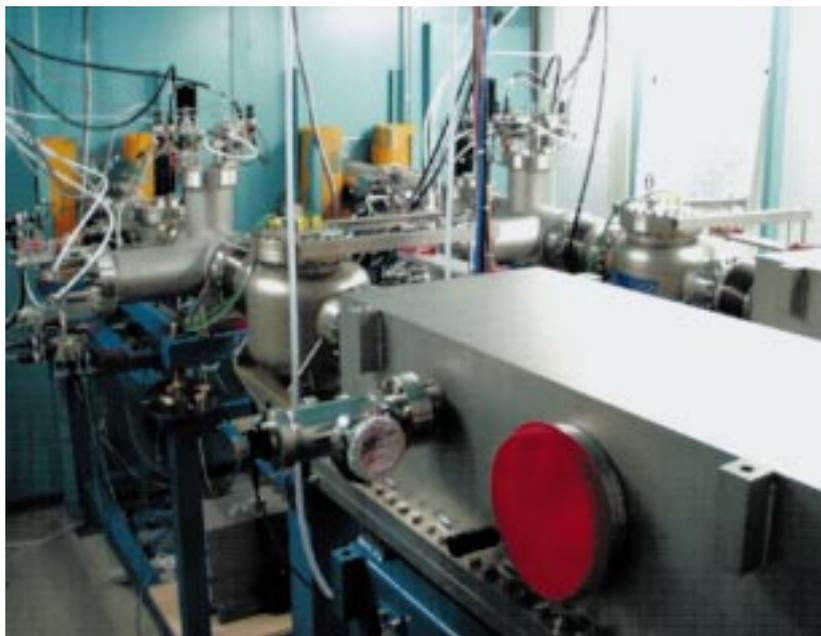
**Abb. 7: Blick auf die beiden Strahlrohre LITHO 1 und LITHO 2 im Bereich der optischen Aufbauten. Im Vordergrund ist die Vakuumschleife des Spiegels von LITHO 2 zu erkennen. Im Hintergrund erkennt man die Strahlmonitore beider Strahlrohre.**
