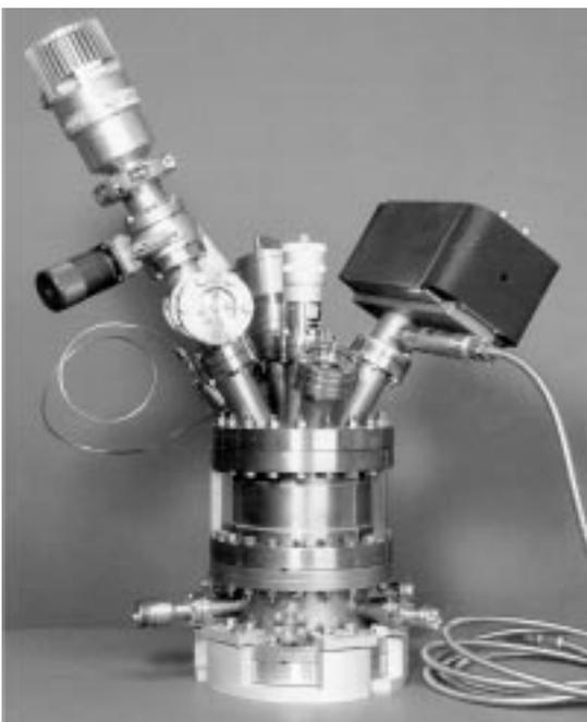
**Abb. 2:** Typische UHV-Kammer als Probenumgebung für In-situ-Röntgenstreuungsexperimente, die auf dem 6-Kreis-Diffraktometer montiert werden kann.
