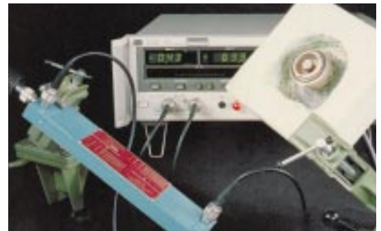
Abb. 3: Messplatz zur Bestimmung von dielektrischen Materialeigenschaften.
