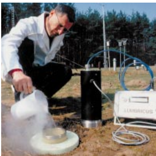
Abb. 6: Befüllung des Glasfaserrohrs mit flüssigem Stickstoff zum Ausfrieren des umliegenden Bodens.
