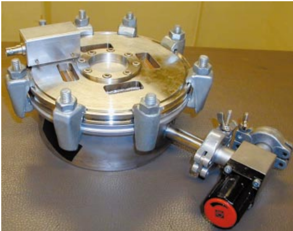
Abb. 4: Photographie des Prototyps der Flüssigkeitsionisationskammer. Die Multipoldurchführungen befinden sich in den rechteckigen Vertiefungen im Deckel, das Aluminiumkästchen mit Koaxialkabelanschluss beinhaltet das Filter für die Hochspannungsversorgung, im Vordergrund das Ventil zum Befüllen der Kammer.
