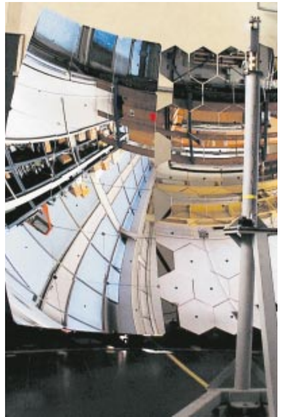
Abb. 5: Prototypaufbau eines gemischten Spiegelsystems im Institut für Kernphysik. Es besteht aus 18 Aluminiumspiegeln und 40 hexagonalen Glasspiegeln.
