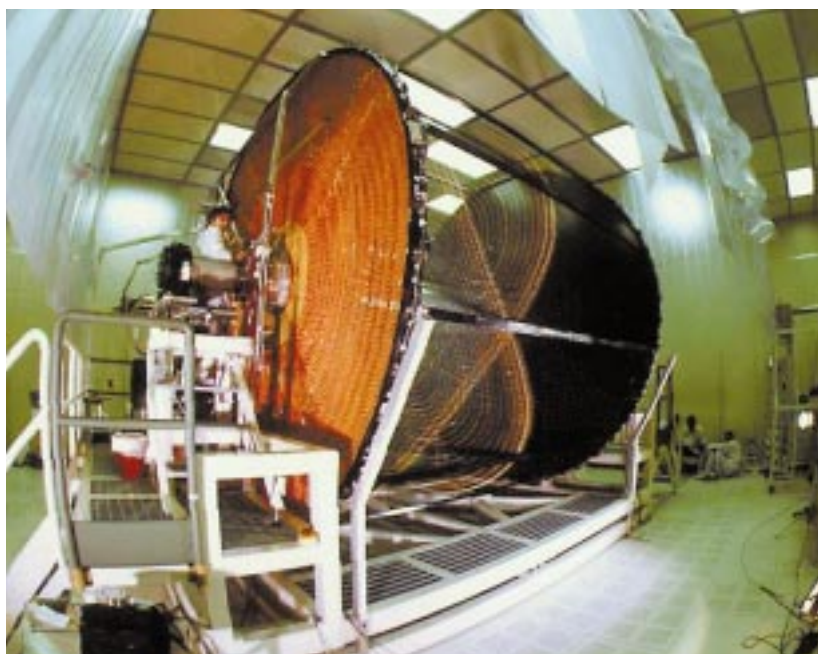
Abb. 3: Die zylindrische Driftkammer von KLOE. Im noch geöffneten Zustand der Kammer erkennt man charakteristische Lichtreflexionen an den etwa 50000 Drähten, die zwischen dem Boden und dem Deckel des liegenden Zylinders gespannt wurden, um die Bahnen geladener Teilchen elektronisch verfolgen zu können.
