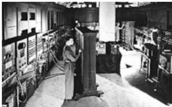
**Abb.1: ENIAC I, Electronical Numerical Integrator And Calculator (Gewicht: 30 Tonnen).**
