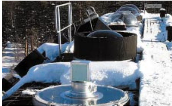
Abb. 3: Links: Das Periskop von MIRA 2 (vorne) und der Sonnensucher des FTIR (hinten) auf dem Dach des IRF in Kiruna. Rechts: Der Messcontainer des FTIR auf Teneriffa. Beide Messstandorte bieten aufgrund der hohen Transparenz der Atmosphäre ausgezeichnete Voraussetzungen für bodengebundene Messungen.
