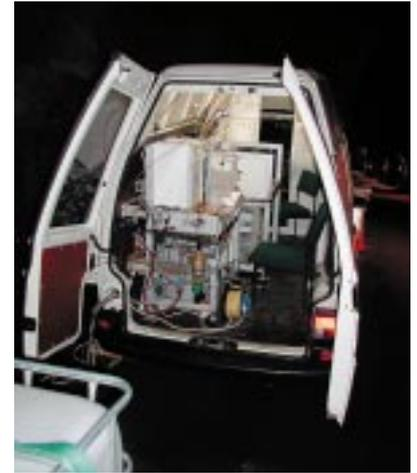
**Abb. 1: In-situ-Kolloiddetektion mit einer mobilen LIBD-Anlage (Eigenentwicklung) im Untertagelaboratorium Äspö (Schweden).**
