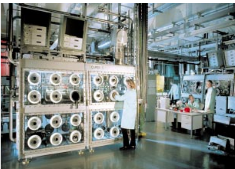
Abb. 3: Blick in das Tritiumlabor Karlsruhe (TLK): Das radioaktive Wasserstoffisotop Tritium wird in Anlagen prozessiert, die in Handschuhkästen als zweiter Barriere gegen den Austritt von Tritium untergebracht sind.
