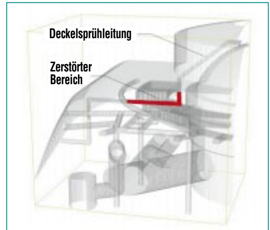
Abb.1: „Glasmodell“ des oberen Teils des KKB-Sicherheitsbehälters in der Nähe der durch Radiolysegasdetonation beschädigten Deckelsprühleitung. Geometriemodell für die COM3D-Simulation mit 5 Millionen kubischen Rechenzellen von 4 cm Kantenlänge.
