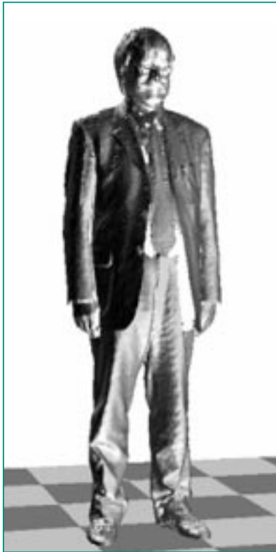
Abb. 5: Mit einem Laser-Scanner hergestelltes Oberflächenmodell eines Probanden
