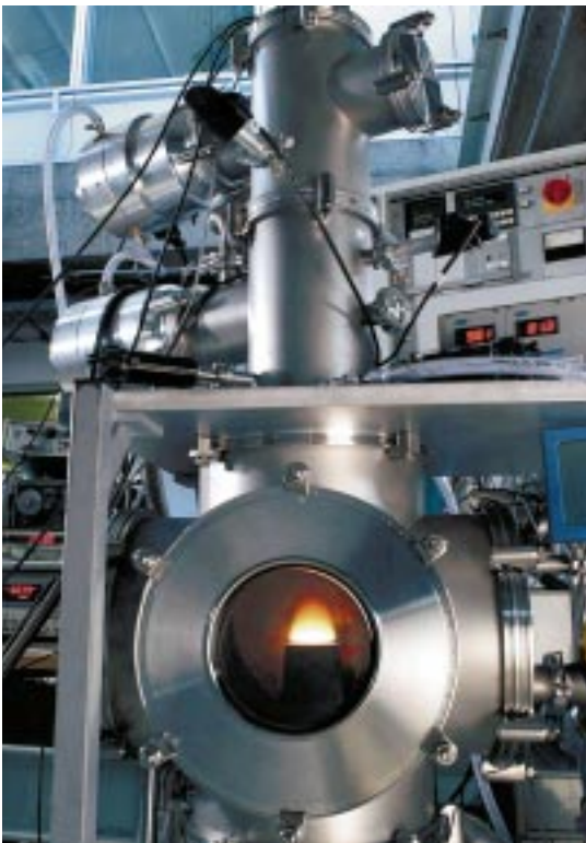
Abb. 2: Zur Messung der Partikelgrößenverteilung von Ruß und Metalloxiden in der Flamme wurde das Partikelmassenspektrometer auf einer Niederdruckbrennkammer installiert.
