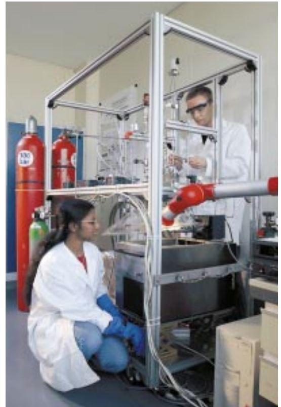
Abb. 7: Sieverts-Apparatur zur Untersuchung thermodynamischer und kinetischer Eigenschaften von Wasserstoffspeichermaterialien.
