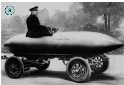
Abb. 1: a) Der Inhaber des Geschwindigkeitsrekords im Jahre 1899, Jenatzy's Elektrofahrzeug „La jamais contente“, mit dem 105,8 km/h erreicht wurden (2 Elektromotoren mit insgesamt 68 PS, Fulmen Batterie). b) Brennstoffzellen-Versuchsfahrzeug „HyWire“ der Firma General Motors (2004).
