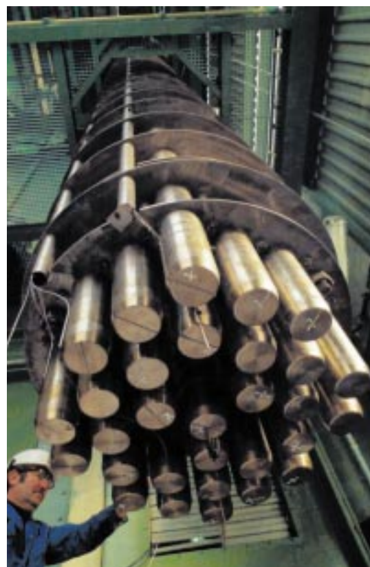
Abb. 1: Reformerrohr-Testbündel zur Erzeugung von Synthesegas unter nuklearen Bedingungen in der EVA-II-Anlage am Forschungszentrum Jülich.
