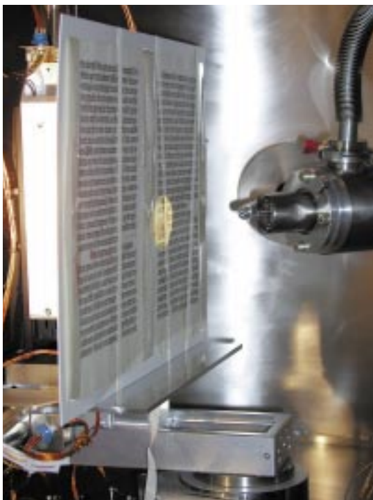
Abb. 4: \mu SyRFA-Aufbau mit spezieller Probenhalterung für die Inkunablen. Der Messbereich wird optisch über eine Kamera im angezeigten Lichtfleck beobachtet.
