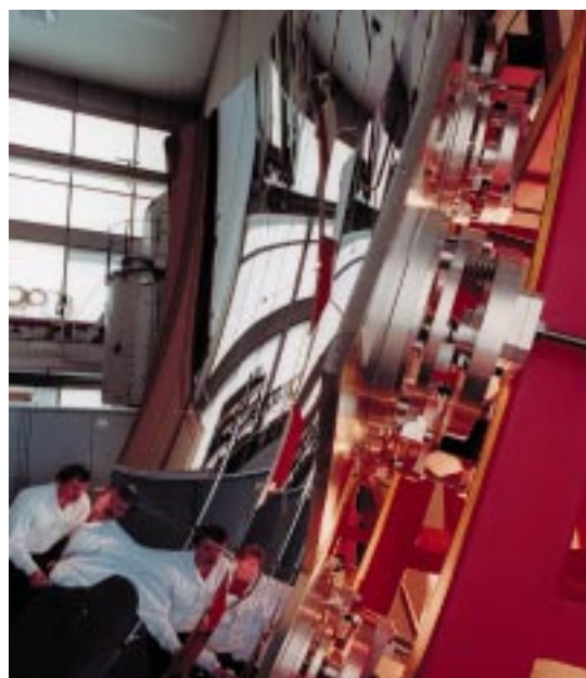
Abb. 1: Spiegel zum Messen der Leuchtspuren der kosmischen Strahlung in der Atmosphäre sind Teil des Pierre-Auger-Observatoriums, das auf einer Fläche von 3500 km 2 in der argentinischen Pampa entsteht und die höchstenergetischen Teilchen im Universum messen soll.
