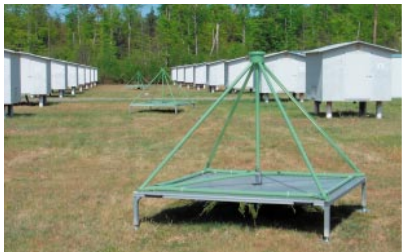
Abb. 1: Teilchendetektoren des KASCADE-Grande-Experiments und Radioantennen des LOPES-Projekts sind integriert, um galaktische kosmische Strahlung zu studieren und neue Technologien zu entwickeln.
