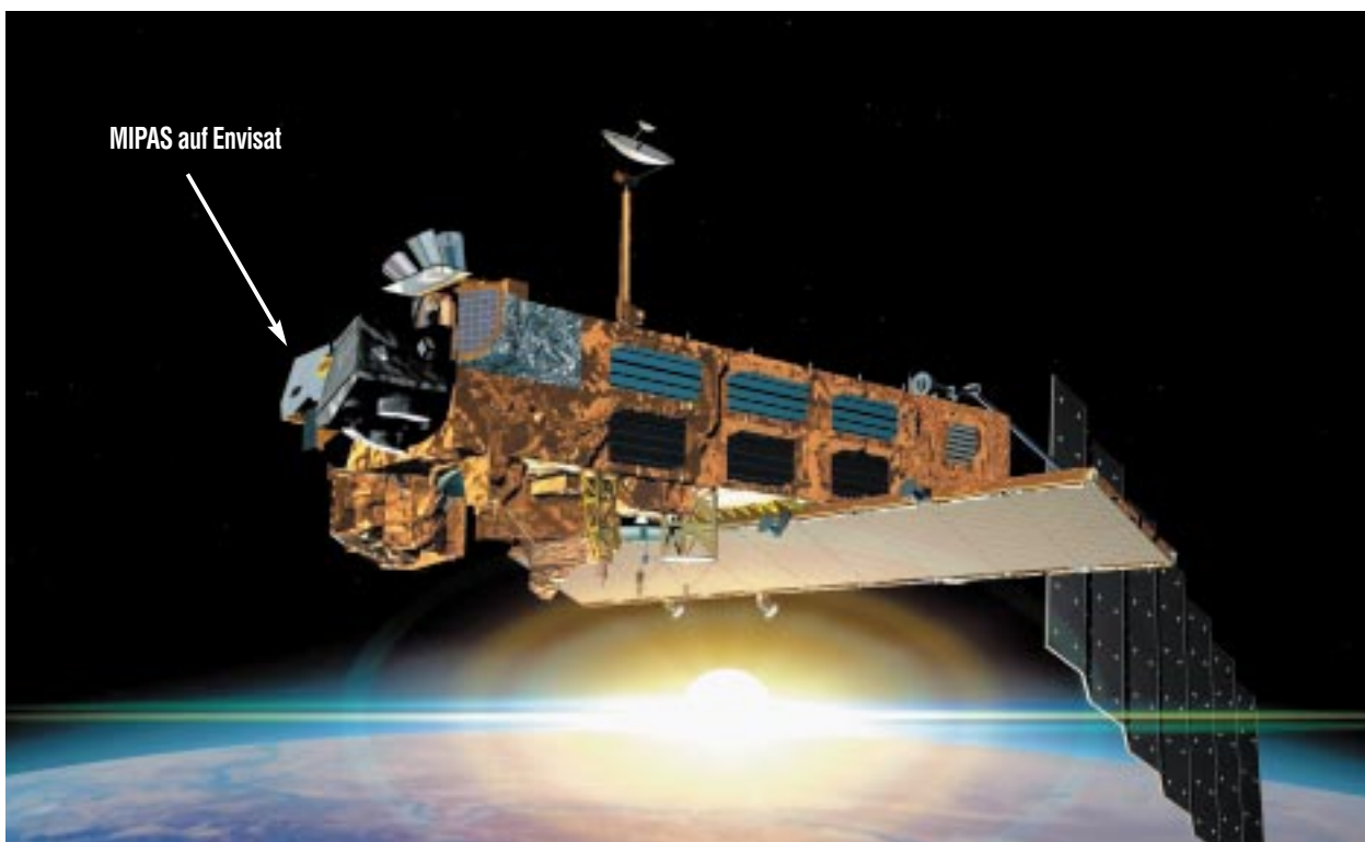
Abb. 2: MIPAS auf dem Umweltforschungssatelliten Envisat (Quelle: ESA).
