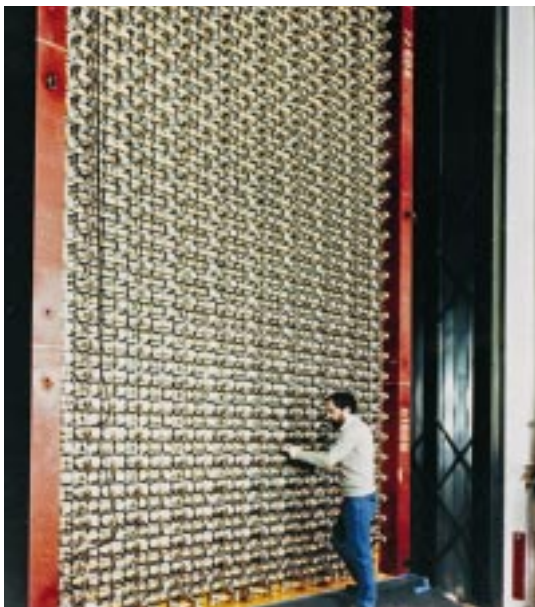
Abb. 2: Der großvolumige Flüssigszintillationsdetektor KARMEN (Karlsruhe Rutherford Mittelenergie Neutrinoexperiment) mit seinen mehr als 2300 Photomultipliern, die das bei Teilchenreaktionen entstehende Szintillationslicht nachweisen, wurde von Wissenschaftlern des Forschungszentrums Karlsruhe bis 2001 am Rutherford-Appleton-Laboratorium bei Oxford betrieben.
