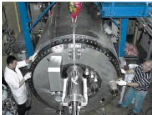
Abb. 3: Beispiele für am Forschungszentrum ausgeführte Kryopumpen für die Kernfusion: Die zylindrische Modellpumpe für ITER (oben links mit Blick auf die Ventilseite, unten beim Einbau) und die Rechteckpumpe für die Plasmaheizung (rechts).
