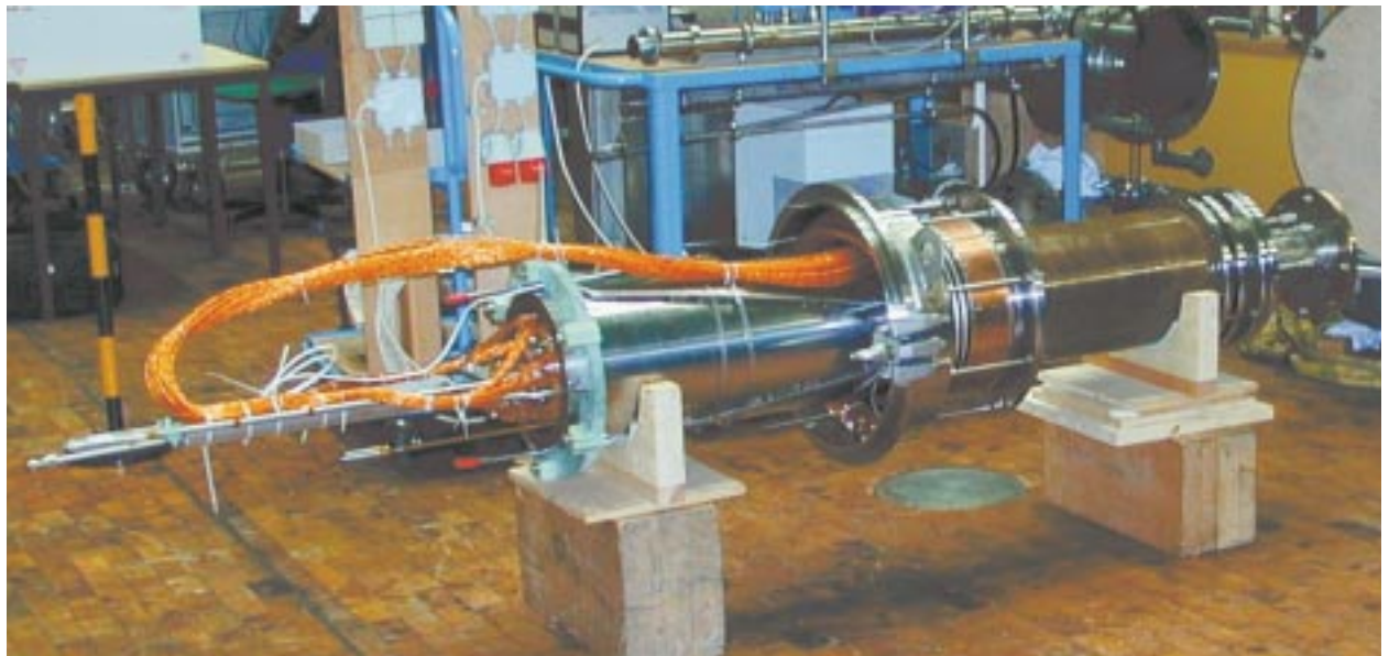
Abb. 2: Die HTSL-Stromzuführung vor dem Einbau in den Testkryostaten.
