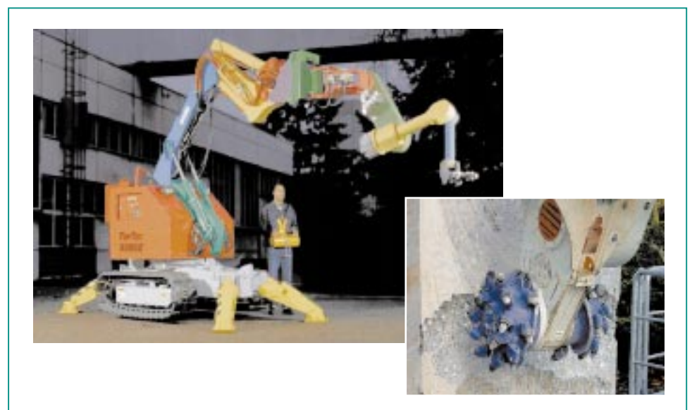
Abb. 7: Bagger mit Fernhantierungseinrichtungen.
