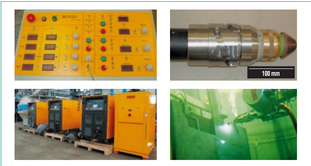
Abb. 4: Anlagen, Brenner und Kalterprobung (Bedienpult, Plasmaquellen (900 A, 225 kW) und Kühler, Wechselbrenner, Kalterprobung im VA Kahl).
