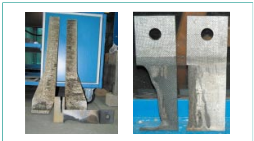
Abb. 6: CAMC-Schnitt in Mock-Up – Reduzierung des Elektrodenverschleißes auf 1/10.
