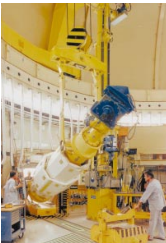
Abb. 3: Handhabung von Brennelementen.
