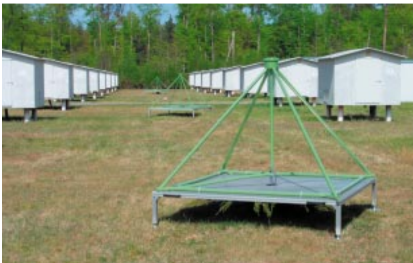
Abb. 3: Drei LOPES-Radioantennen zwischen Teilchendetektoren von KASCADE-Grande auf dem Gelände des Forschungszentrums Karlsruhe.
