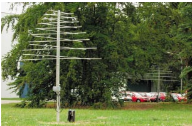
Abb. 8: Kreuzpolarisierte logarithmisch-periodische Dipolantennen der LOPES STAR -Empfängerstationen.
