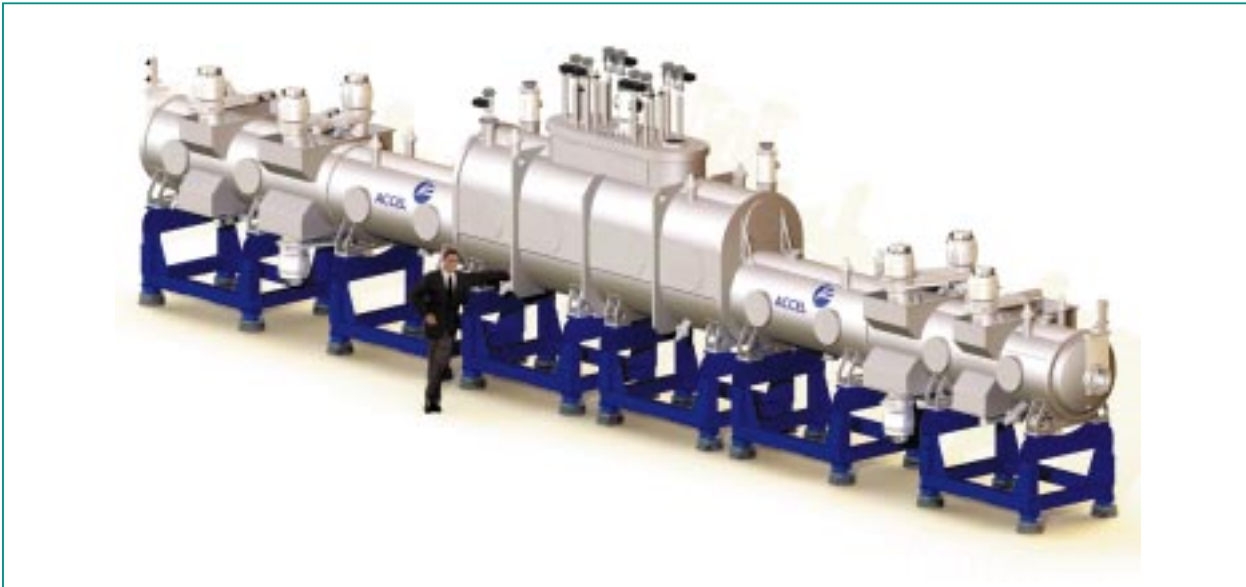
Abb. 4: Die fensterlose gasförmige Tritiumquelle WGTS ist eine der beiden Schlüsselkomponenten von KATRIN und liefert 100 Milliarden \beta -Zerfälle pro Sekunde. Die technologischen Anforderungen an den 16 m langen Kryostat sind herausfordernd. Entsprechend komplex ist sein innerer Aufbau mit insgesamt sechs verschiedenen kryogenen Fluiden (Helium, Neon, Stickstoff, Argon, Tritium, Krypton), 12 Kryokreisläufen und mehr als 500 Sensoren.
