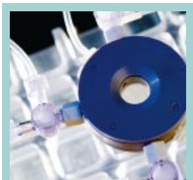
Der am Forschungszentrum Karlsruhe entwickelte CellChip ist eine mikrostrukturierte Gerüststruktur für die dreidimensionale Kultivierung von Zellen.
