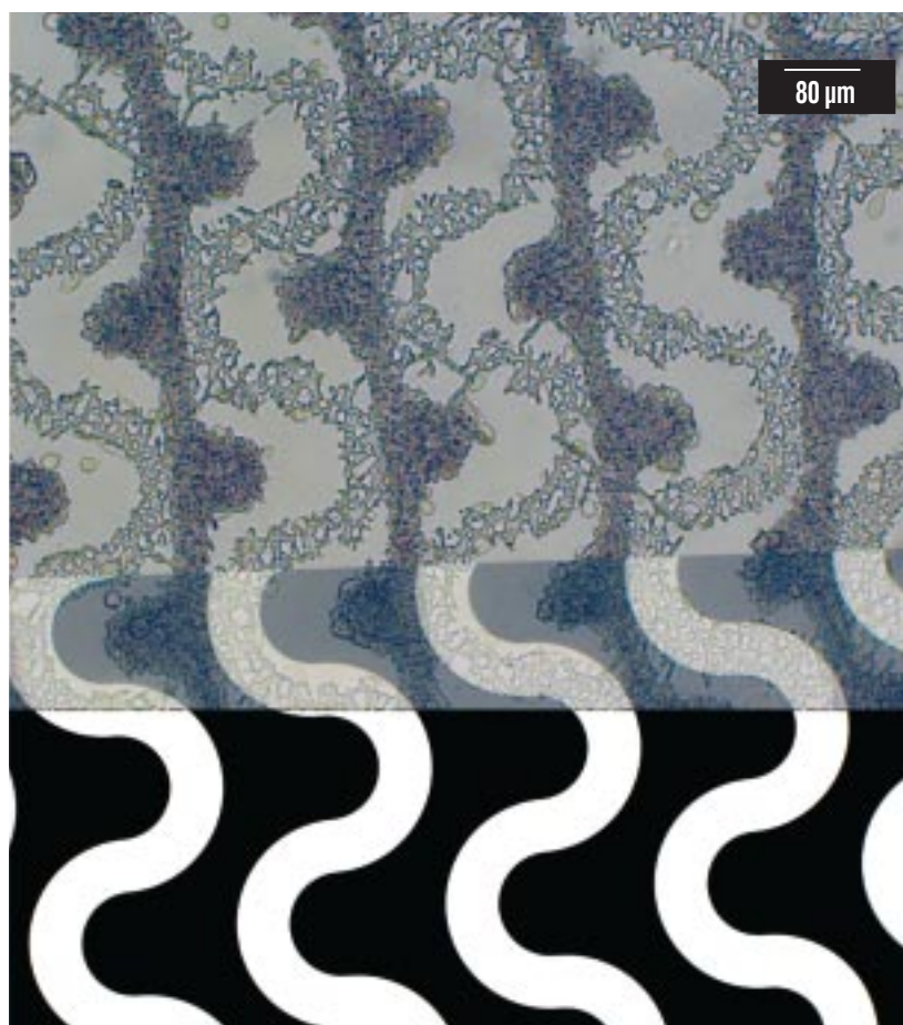
Abb. 4: Fotomontage. Oben: Durch UV-Bestrahlung modifizierte Schicht aus PPC-Nanofasern auf einem Deckgläschen. Mitte und unten: Die verwendete Lithographiemaske im gleichen Maßstab.
