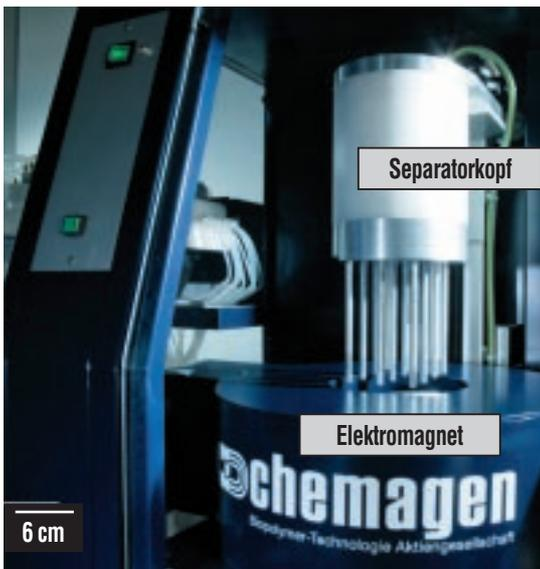
**Abb. 3:** Detailansicht des chemagic Magnetic Separation Module I der Firma chemagen. Zu sehen sind der Elektromagnet sowie der verfahrbare Separationskopf mit in diesem Fall zwölf magnetisierbaren sowie um ihre Achse rotierbaren Metallstäben. Durch Einfahren des Separatorkopfs in die Bohrung des eingeschalteten Magneten werden die Stäbe temporär magnetisiert, wodurch sich in Probenmaterial suspendierte magnetische Mikropartikel an den Stäben anlagern.
