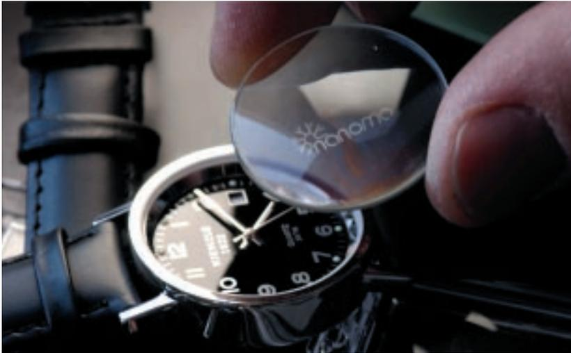
**Abb. 3: Antireflexbeschichtetes Uhrenglas mit „Antireflex-Wasserzeichen“ (nanomat-Logo), welches nur in Reflexion – also nur unter einem bestimmten Betrachtungswinkel – zu sehen ist.**
