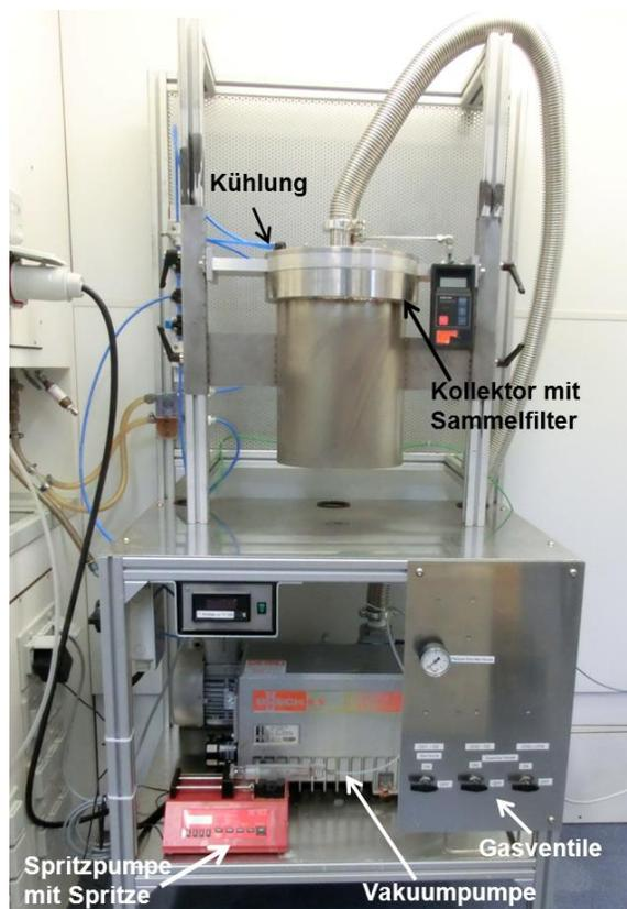
Abb. 2-2. Darstellung der FSP-Apparatur am KIT.
