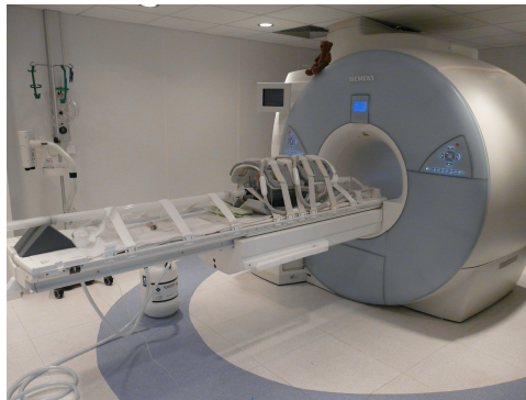
Abb. 8.5: Phantomaufbau in einem Magnetresonanztomographen.
