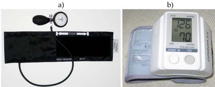
Abb. 2.8: a) Blutdruckmanschette zur palpatorischen oder auskultatorischen Messung am Oberarm. b) Blutdruckmanschette zur automatisierten oszillometrischen Messung am Handgelenk.
