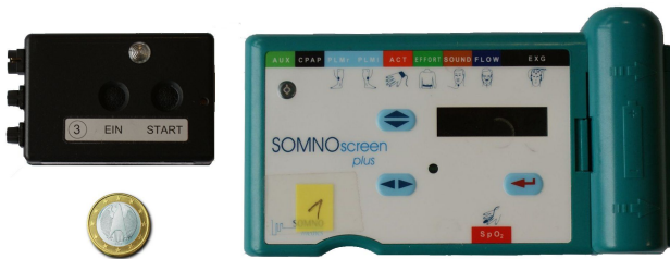
Abbildung 3.1: Unterschiedliche Arten mobiler Polygraphen zur Aufzeichnung physiologischer Signale. Links: Varioport-e ohne Medizinproduktzulassung, Rechts: Somnoscreen mit Medizinproduktzulassung
