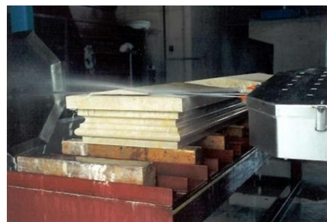
Abbildung 11: Profilierung eines Pfeilerabdeckers [36]
