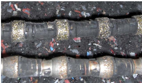
Abbildung 39: konischer Verschleiß der Diamantsegmente im Vergleich zu Neuzustand
