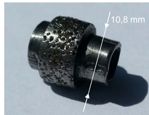
Abbildung 27: Galvanisches Segment mit Verschleißerscheinungen
