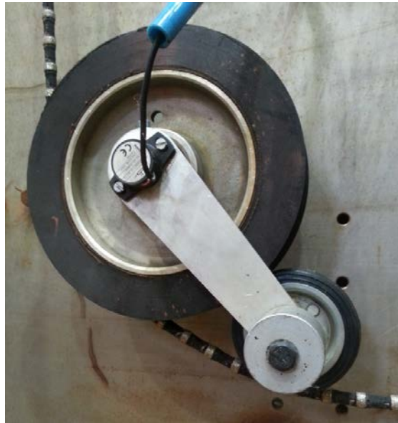
Abbildung 101: Aufbau für den Drehwinkelsensor
