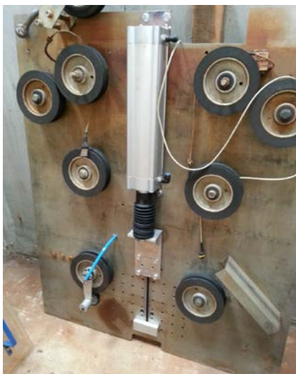
Abbildung 95: Zur Tauchseilsäge umgerüsteter Versuchsstand
