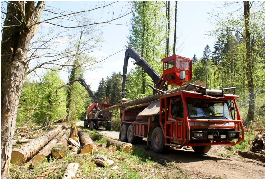
Abbildung 5.1: Beispielanwendung – Aufgabekran einer mobilen Holzentrindungsmaschine
