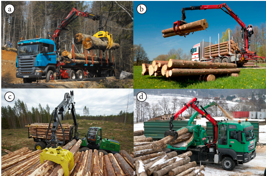
Abbildung 2.11: Beispiele diverser Forstkrane: |a Langholztransporter /SCA 2013/, |b Kurzholztransporter /PAL 2013/, |c Forwarder /DEE 2013/ und |d Mobilhacker /JEN 2013/
