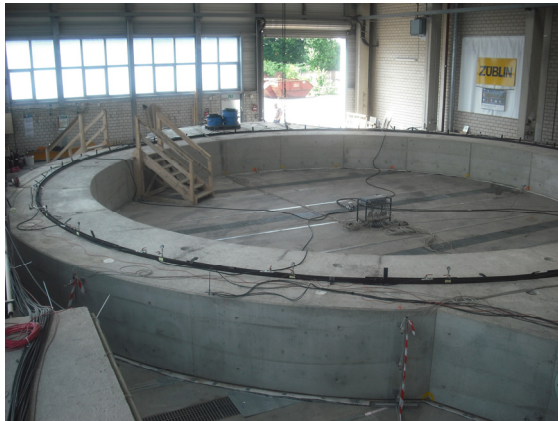
Abb. 11 Versuchsaufbau für Belastungsversuche mit innerem Druckring und eingebauten Druckkissen
