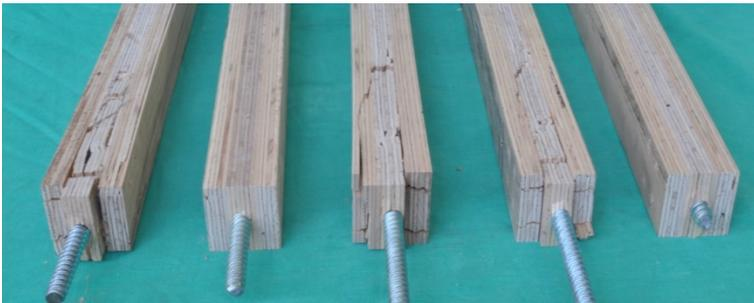
Bild A-3 Versagensbild der maßgebenden Verbindung der Reihe 13
