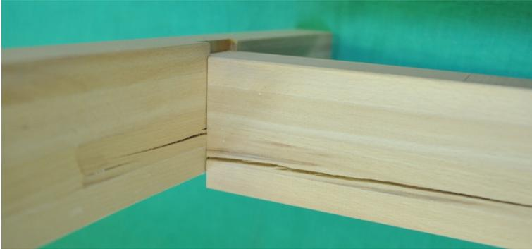
Bild 3-43 *Typisches Versagensbild im Lastfall „Winddruck“ – Reihe D2*
