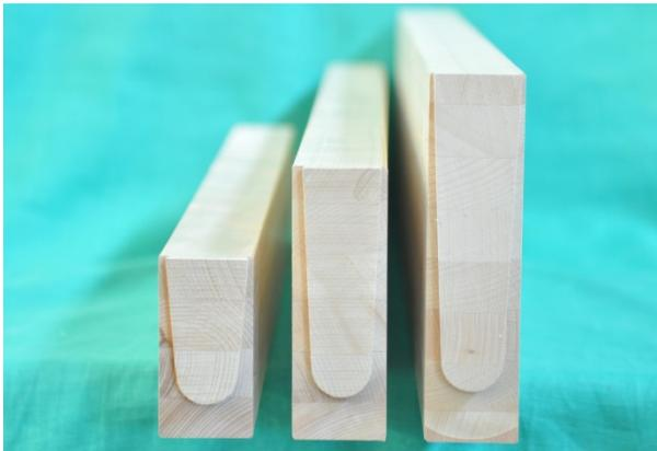
*Bild 3-30 Variation der Bauteiltiefe (100 mm, 150 mm und 200 mm) bei gleichbleibender Bauteilbreite (50 mm)*
