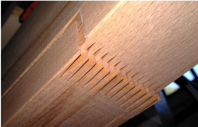
Bild A-59 Fehlerhafte Verklebung der Keilzinkung – Unterseite des Riegels
