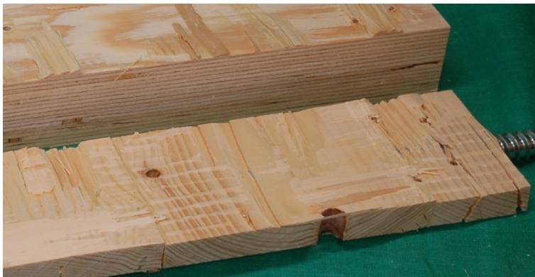
*Bild A-6 Mangelhafte Verklebung – aufgetrennter Prüfkörper der Reihe 6*
