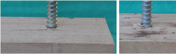
Bild 2-25 Typische Versagensbilder;  $\alpha = 90^\circ$  (links) und  $\alpha = 45^\circ$  (rechts)
