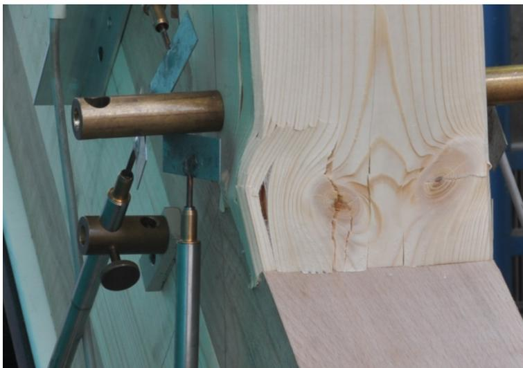
*Bild A-20 Versagen der Strebe; Reihe 6*
