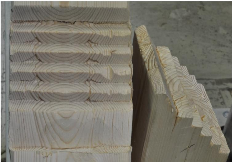
*Bild A-18 Scherversagen im Gurtbauteil des Fichten-BSH; Reihe 5*
