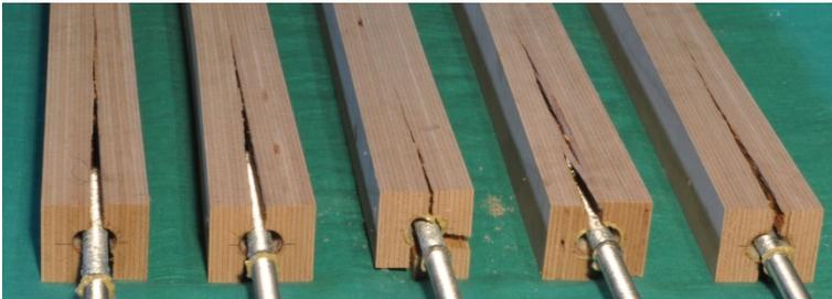
Bild A-7 Versagensbild der maßgebenden Verbindung der eingeklebten GS in Buchen-FSH ohne Querbewehrung
