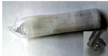
Abbildung A.3: Die Temperatur war zu lange bei 1200°C, das Quarzglas hat sich stark verformt.
