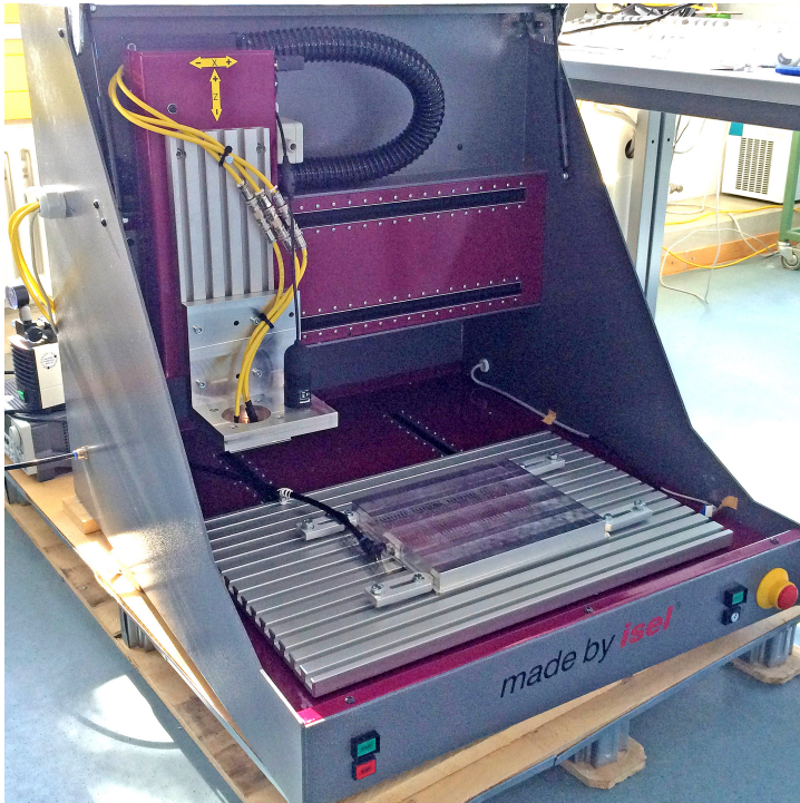
Bild 4.2.: Reihenmessplatz vor der Installation. Zu erkennen sind der Messkopf mit gelben TRIAX-Kabeln und die Vakuum-Spannplatte zur Fixierung der Substrate.
