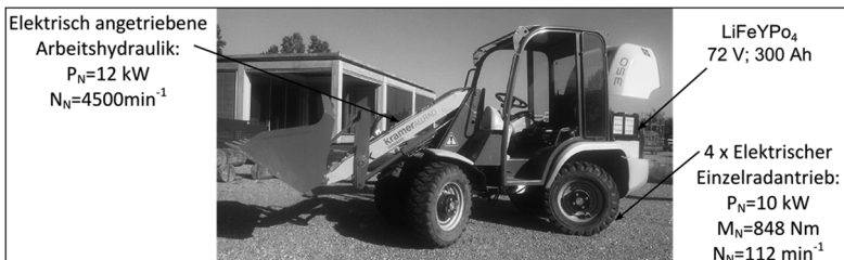
Abb. 4: Antriebskomponenten des Elektro-Radladers
