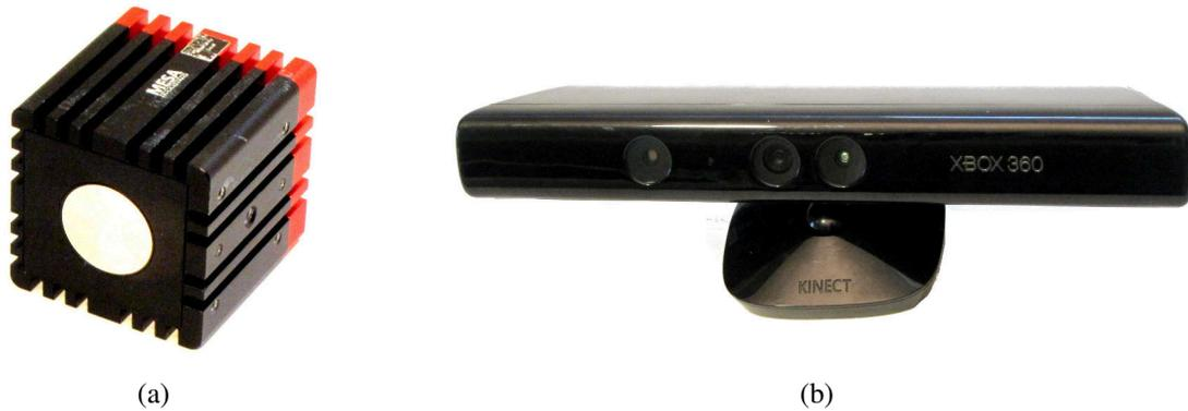
Abb. 8.2.: Abbildung der zur Hindernissmodellierung verwendeten Tiefenbildsensoren. (a): Swissranger 4000 der Firma Mesa Imaging, der sowohl auf dem DESIRE Demonstrator als auch auf dem zweiarmigen FZI Demonstrator eingesetzt wurde. (b): Kinect Sensor der Firma Microsoft.
