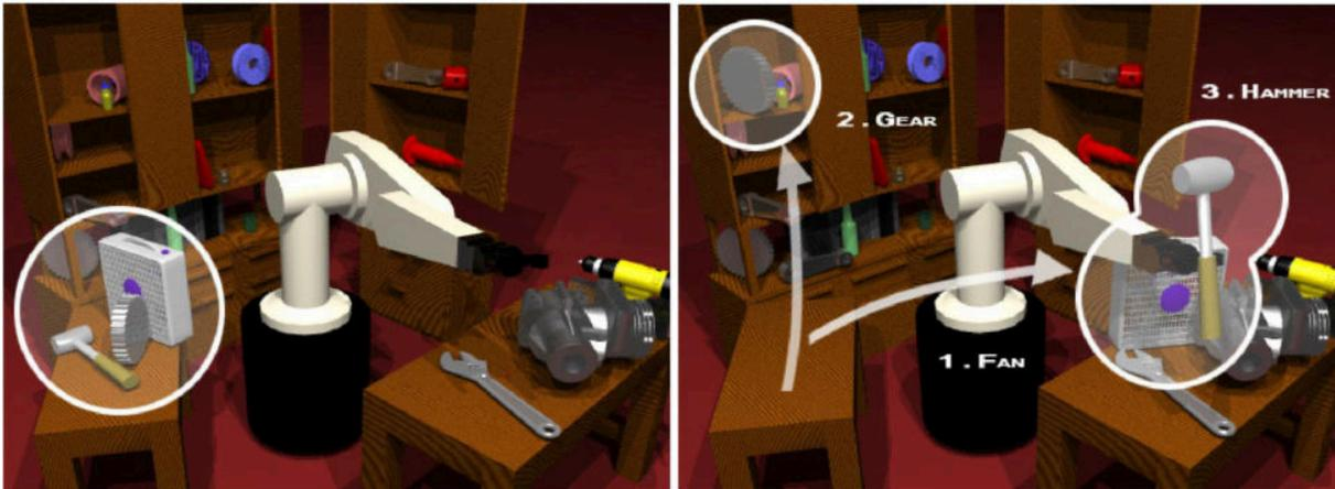
Abb. 3.7.: Planungsszenario des Manipulationsplaners aus (Stilman u. a., 2007). Der Hammer soll ge-griffen werden, dazu müssen die beiden Objekte davor entfernt werden. Sie werden an durch Abtastung erzeugte Orte gelegt. Angepasst übernommen aus (Stilman u. a., 2007).
