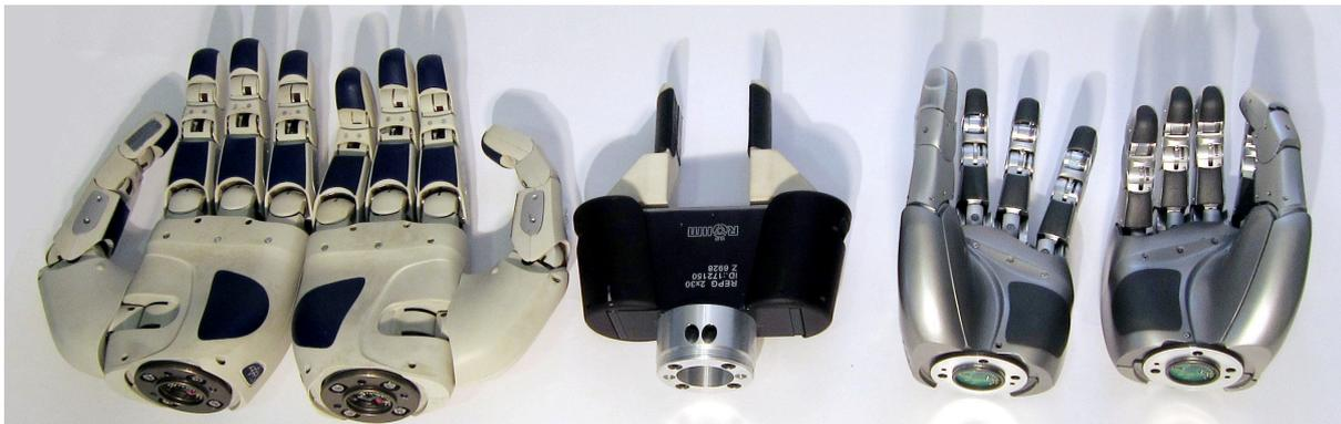
Abb. 8.3.: Abbildung der zur Evaluation verwendeten Greifer. Von Links nach rechts: Schunk Anthropomorphe Vierfingerhand (SAH), Röhm Zweibackengreifer REPG 30 und DLR/HIT Fünffingerhand.
