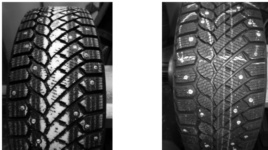
Abbildung 4.10: Lauffläche des Reifens nach einem Versuchsdurchlauf ohne (links) und mit installierter Absaugung des Eisstaubs (rechts)
