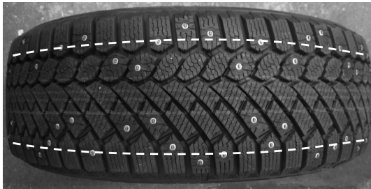
Abbildung 2.2: Anordnung der Spikes auf einem handelsüblichen Spikereifen. Die gestrichelten Linien markieren beispielhaft die Spuren für die Queranordnung der Spikes.
