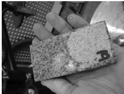
Abbildung 4.18: Probenkörper während des Trocknungsvorgangs, trockene und nasse Bereiche der Oberfläche sind leicht zu unterscheiden.
