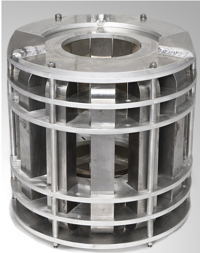
Abb. 8.5 Fertig montierter Aubert-Magnet mit zwei Ringen, die n = 12 Magnete ( 35 \times 35 \times 70 mm) aus NdFeB der Stärke N48 ( B_r = 1,4 T, abhängig vom Lieferanten) und zwölf Eisenstäbe (1.4016 oder AISI 430) um die Magnetringe herum aufweisen. Die Gesamthöhe beträgt 300 mm.
