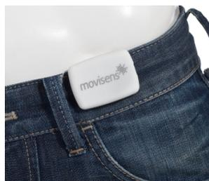
**Abbildung 4.5:** Der Beschleunigungssensor „Move II“ - Anbringung an der Hüfte
