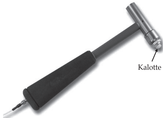
Abbildung 7.7. Kistler-Impulshammer mit integriertem Kraftsensor.
