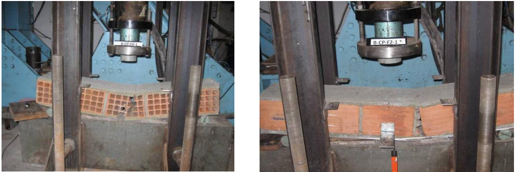
Abb. 4.93: 3-Punkt Biegeversuche eines vertikalen unverstärkten Wandausschnitts (links), horizontaler verstärkter Wandausschnitt (rechts)
