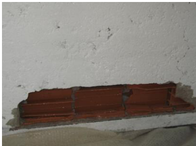
Abb. 4.106: Versagen der unteren Steine auf Schub (analog dem Rollschub) (links); Gesamtkollaps der unverstärkten Wand, keine Schäden an der verstärkten Wand (rechts)
