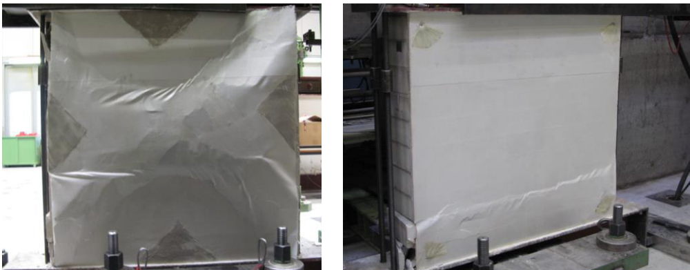
Abb. 4.34: Versagensbild Wand (W11) (links); Versagensbild Wand (W12) (rechts)
