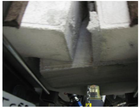
Abb. 4.83: Stufenförmiger Riss der Probe (O1) (links); Torsion und Verschiebung in den Fugen am Mittelstein, Probe (O1) (rechts)
