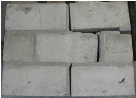
Abb. 4.83: Stufenförmiger Riss der Probe (O1) (links); Torsion und Verschiebung in den Fugen am Mittelstein, Probe (O1) (rechts)
