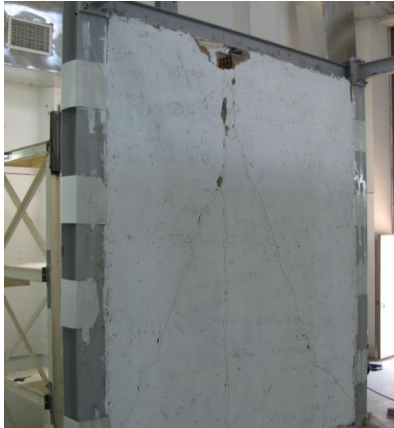
Abb. 4.105: Rissbild entsprechend der Bruchlinientheorie (links); Kollaps des inneren Dreiecks (rechts)
