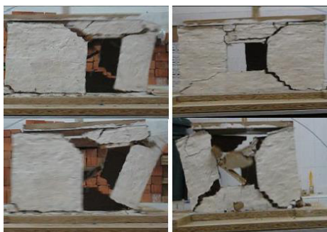
Abb. 4.41: Gebäudegeometrie (links), Ergebnisse der verstärkten Modellgebäude (rechts) aus [118]
