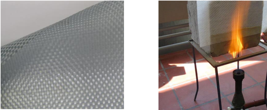
Abb. 3.45: Sehr dünnes biaxiales Glasfasergewebe mit Klebstoffimprägnierung (links), Brandversuchs (rechts)
