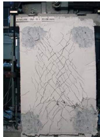
Abb. 3.24: Hysteresekurve der verstärkten Natursteinwand im Vergleich zur Referenzwand (in grün) (links), Rissbild der Wand (rechts) aus [226]
