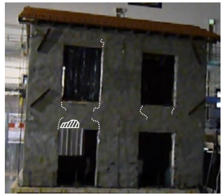
Abb. 4.56: Einbettung der durchgehenden Gewebbahnen (links), Geschädigtes Gebäude (G2), (gestrichelt Risse in Fasern und schraffiert Delamination) (rechts)
