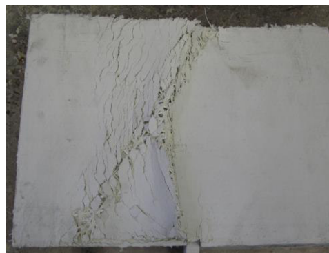
Abb. 4.86: Faserversagen der Probe (O12) (links), Herauslösen der Fasern aus dem weichen Kalk-Zement-Mörtel bei Probe (O18) (rechts)
