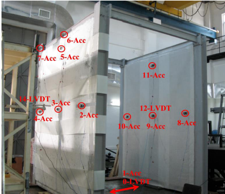
Abb. 4.97: Anordnung der Beschleunigungs- (ACC) und der Verschiebungsmesser (LVDT) an den Wänden
