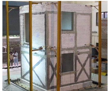
Abb. 4.76: Geometrie der Streifenverstärkung auf der Nord- und Ostseite von Gebäude (G4) (links), und der Süd- und Westseite (rechts)
