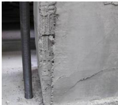
Abb. 4.28: Schubversagen bei Wand (W5) (links); Delamination bei Wand (W6) (rechts)
