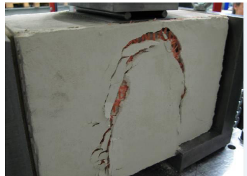
Abb. 4.17: Schollenförmiges Versagen der oberen Deckschicht (Mörtelschicht 2) bei dünnem Materialauftrag (S15) (links), Abb. 4.18: Verbundversagen Faser-Mörtel bei dickerer Deckschicht des Versuchskörpers (S16)
