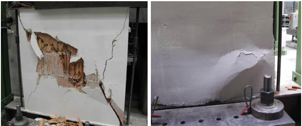
Abb. 4.26: Steinversagen in Wandmitte (W3) (links), Schalenablösung/knicken bei Wand (W4) (rechts)
