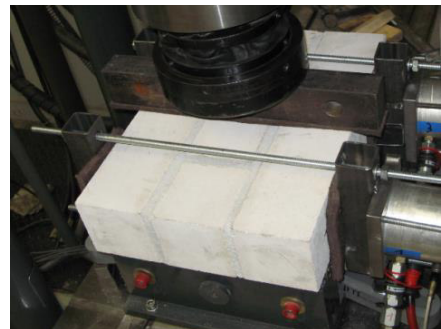
Abb. 4.84: Ovale Versagenszone der Verstärkung bei Probe (O4), (rechts); Aufsicht des Versuchsaufbaus (rechts)
