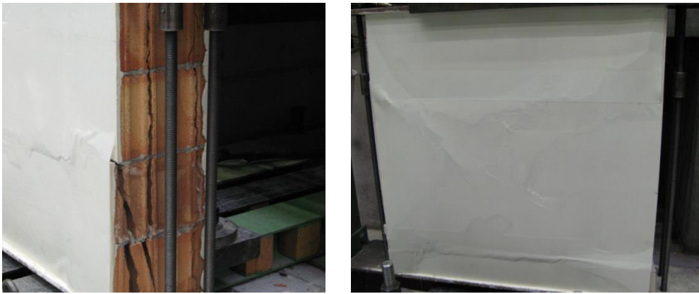
Abb. 4.33: Versagensbild Wand (W9) (links); Versagensbild Wand (W10) (rechts)
