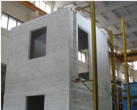
Abb. 4.66: Gebäude (G3) mit Senorenmast für die Verschiebungsmessung (links), Verschiebungsmesser mit Spiegel-Laser-System (rechts)
