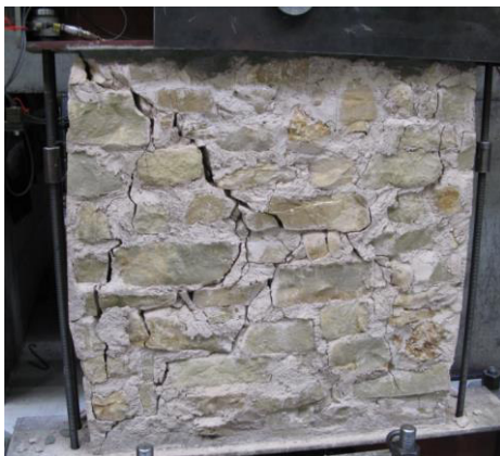
Abb. 4.24: Unverstärkte (links) gerissene Wand (W1) mit großen Einzelrissen, verstärkte (rechts) fein gerissene Wand (W2)
