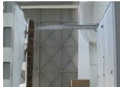
Abb. 4.106: Versagen der unteren Steine auf Schub (analog dem Rollschub) (links); Gesamtkollaps der unverstärkten Wand, keine Schäden an der verstärkten Wand (rechts)
