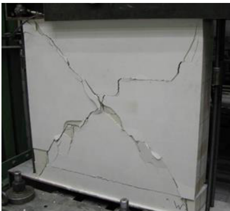
Abb. 4.28: Schubversagen bei Wand (W5) (links); Delamination bei Wand (W6) (rechts)
