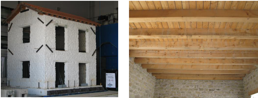
Abb. 4.42: Natursteingebäude unverstärkt (links), Holzbalkendecke im EG (rechts)
