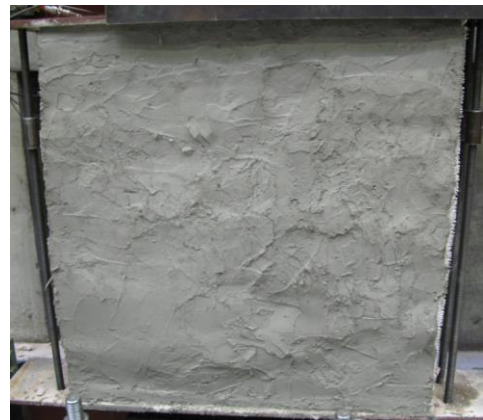
Abb. 4.24: Unverstärkte (links) gerissene Wand (W1) mit großen Einzelrissen, verstärkte (rechts) fein gerissene Wand (W2)
