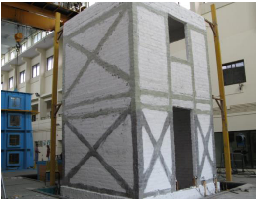
Abb. 4.76: Geometrie der Streifenverstärkung auf der Nord- und Ostseite von Gebäude (G4) (links), und der Süd- und Westseite (rechts)
