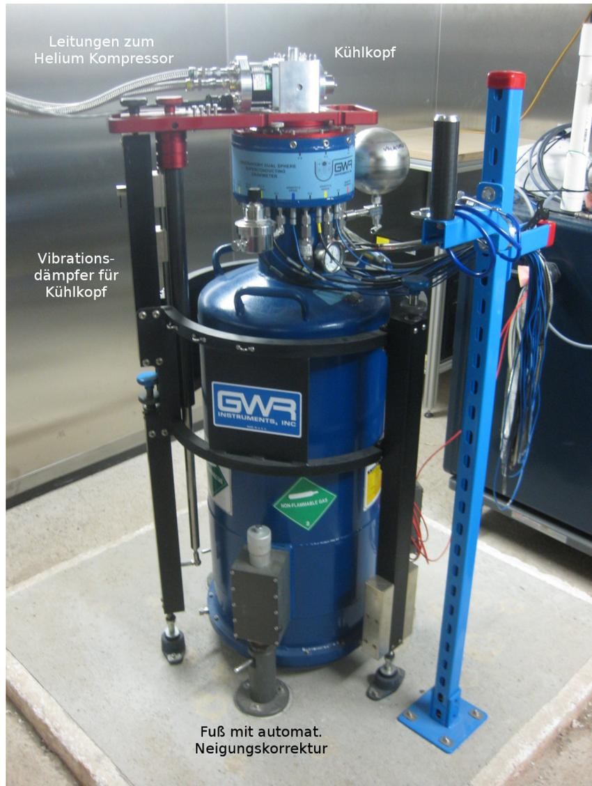
Abbildung 2.5.: Supraleitendes Gravimeter SG056 am BFO. Zu sehen ist der dunkelblaue Dewar, in dem sich die zwei Sensoren direkt übereinander befinden. Links führen Leitungen zum Helium-Kompressor, der sich aufgrund von Wärmeentwicklung nicht direkt am Gravimeter befindet. Rechts ist die Steuerelektronik und Datenerfassungseinheit zu erkennen.
