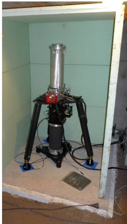
Abbildung 2.12: Installation des FG5 in einer Styroporhütte zur Wärmeisolation vor dem Anbringen der Frontseite
