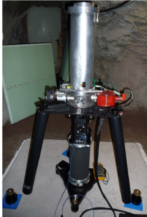
Abbildung 2.8: FG5-101 während des Aufbaus auf dem neuen Vermessungspunkt AG auf dem neuen Gravimetersockel vor der Gravimeterkammer am 27. Januar 2010
