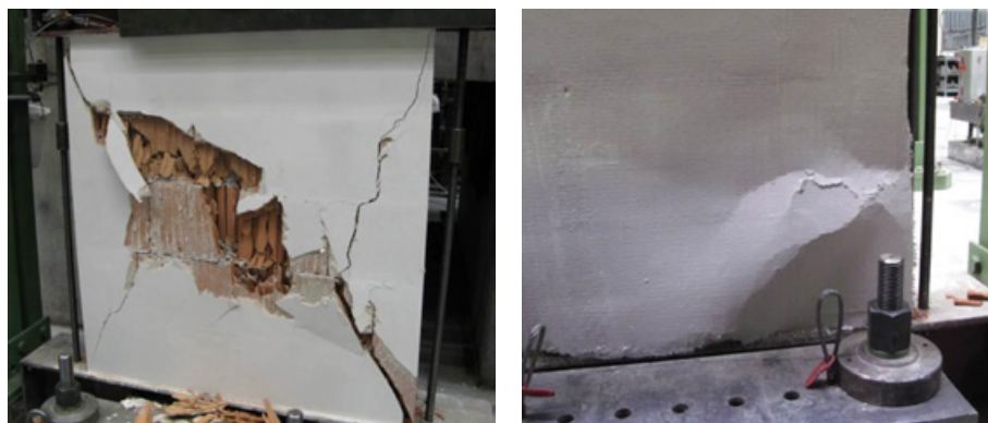
Abb. 4.26: Steinversagen in Wandmitte (W3) (links), Schalablösung/knicken bei Wand (W4) (rechts)
