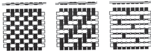
Abb. 3.41: Verschiedene Webtechniken von flachen Rovings, die zu sehr dünnen Gebilden führen, aus [73]
