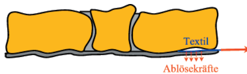
Abb. 4.3: Qualitativer Ablöseeffekt bei unebener Steinoberfläche
