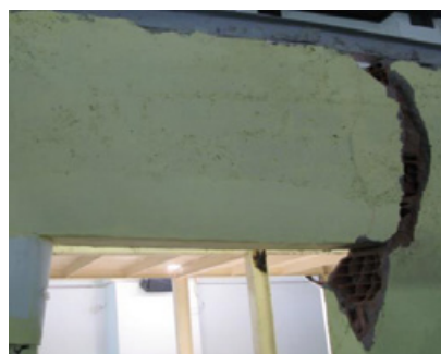
Abb. 4.114: Unverstärkte Wand: Riss an Türecke beginnend, (links); Versagen der unteren Steinreihe auf Schub (rechts)
