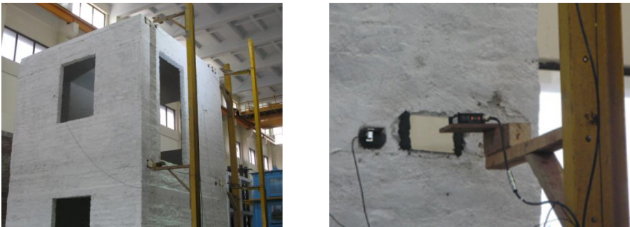
Abb. 4.66: Gebäude (G3) mit Senorenmast für die Verschiebungsmessung (links), Verschiebungsmesser mit Spiegel-Laser-System (rechts)
