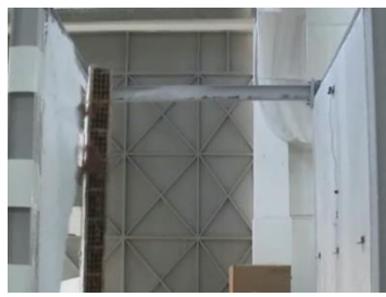
Abb. 4.106: Versagen der unteren Steine auf Schub (analog dem Rollschub) (links); Gesamtkollaps der unverstärkten Wand, keine Schäden an der verstärkten Wand (rechts)
