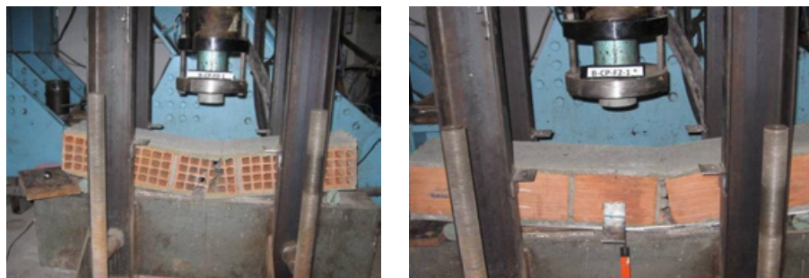
Abb. 4.93: 3-Punkt Biegeversuche eines vertikalen unverstärkten Wandausschnitts (links), horizontaler verstärkter Wandausschnitt (rechts)
