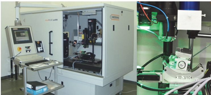
Abbildung 3.6: Lasermikrobearbeitungsanlage microPULSE ps355 der 3D-Micromac AG
